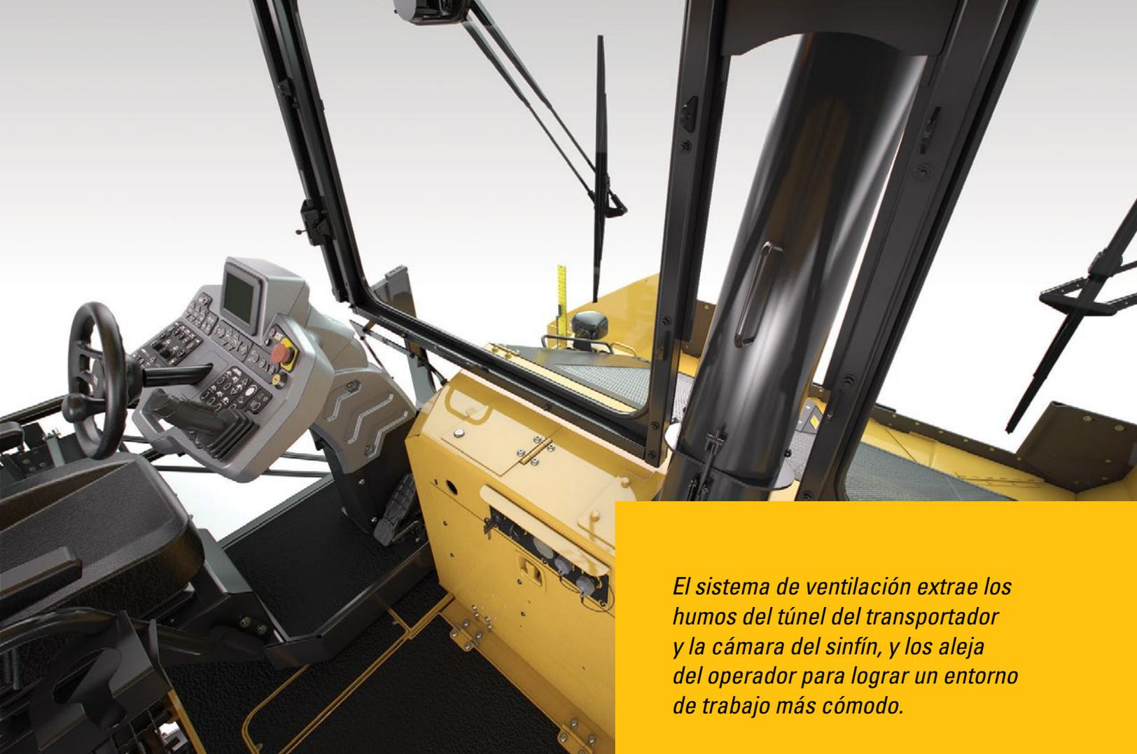
*El sistema de ventilación extrae los humos del túnel del transportador y la cámara del sinfín, y los aleja del operador para lograr un entorno de trabajo más cómodo.*
