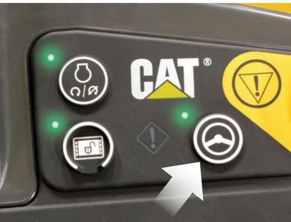
*La configuración de la máquina se transfiere automáticamente entre estaciones; simplemente mantenga presionado el botón para reanudar la pavimentación.*
