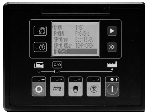
Figura 5.11 – Funzionamento di base del tasto Avviamento
