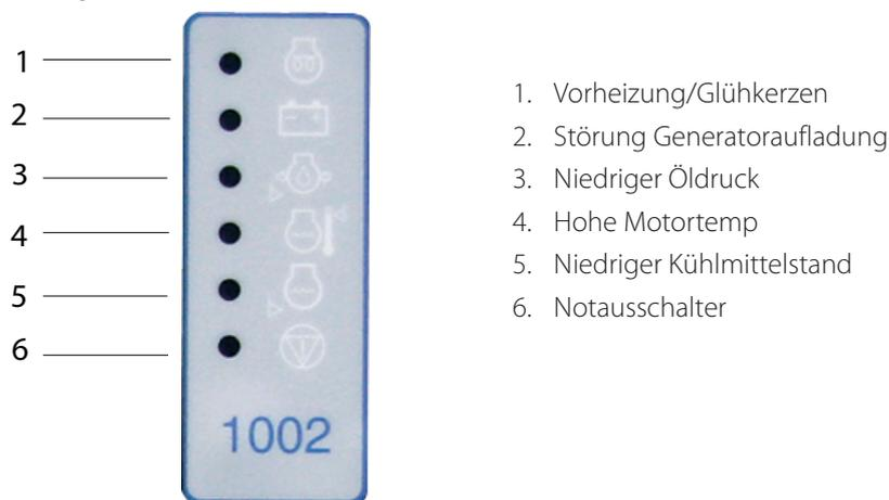
Abbildung 5b – 1002T Fehlerlampen
