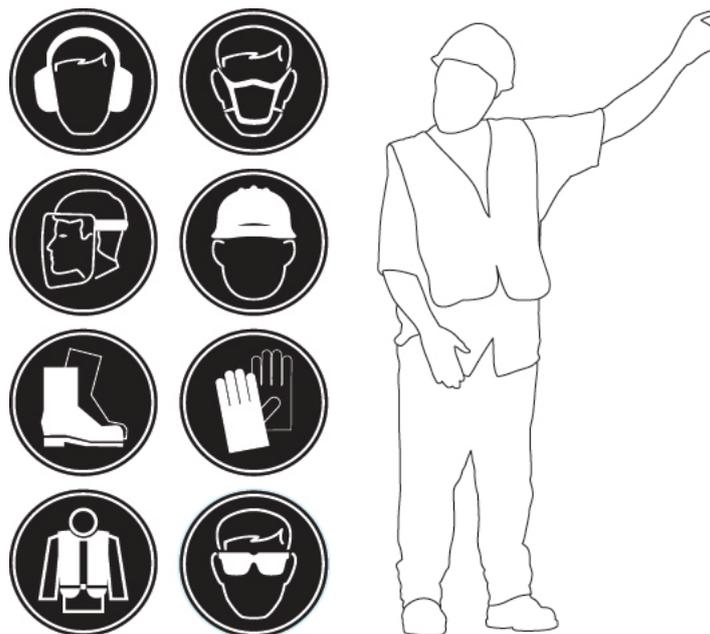
Abbildung 2.1 - Typische persönliche Schutzausrüstung für den Bediener
