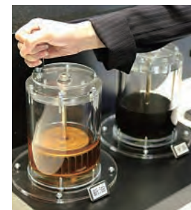
新油から100時間毎のエンジンオイルの変化の様子。稼働時間が長くなるに従ってオイルは劣化していきます。
