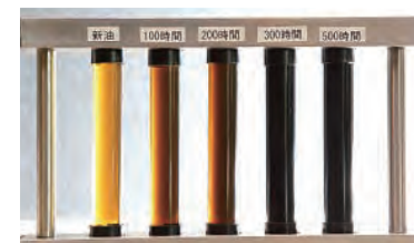
新油から100時間毎のエンジンオイルの変化の様子。稼働時間が長くなるに従ってオイルは劣化していきます。
