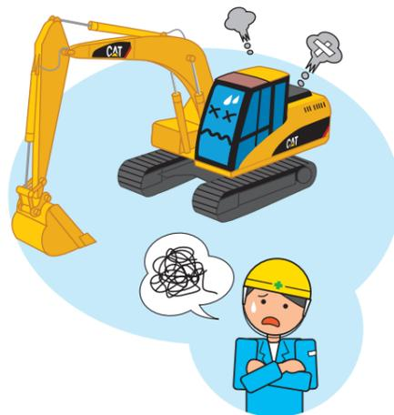
同じように冷却水の点検も重要です。冷却水が不足している状態でエンジンをかけているとオーバーヒートを起こす原因になります。
