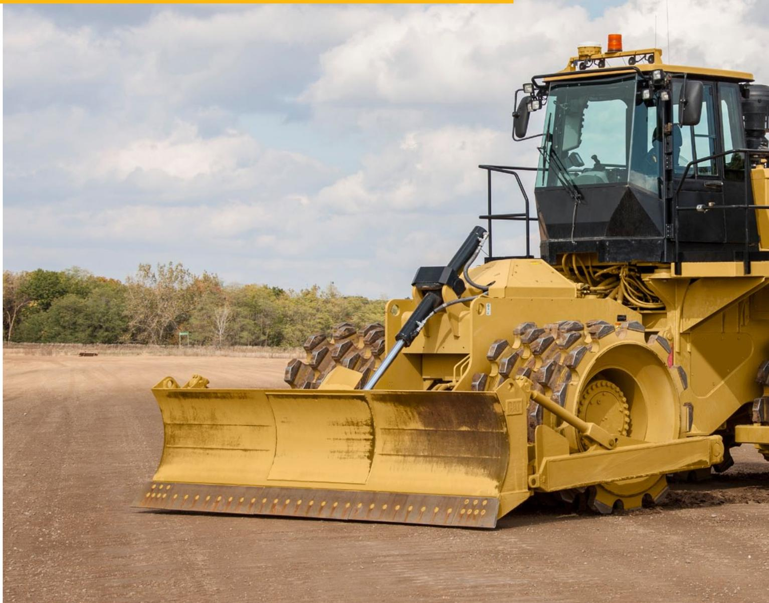
**Мы постоянно совершенствуем нашу продукцию, чтобы обеспечить безопасные условия работы оператора и всего персонала на рабочей площадке. Модель 825K отличается абсолютно новой лестницей для доступа в кабину и к ключевым точкам технического обслуживания.**
