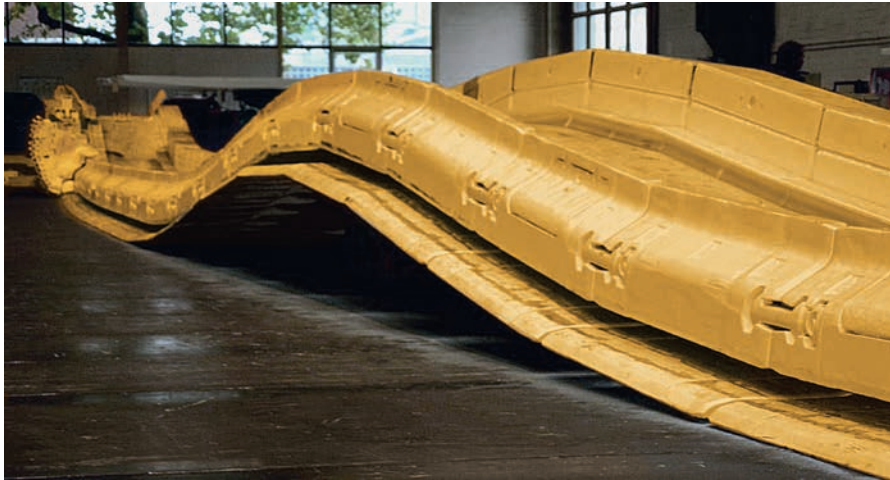
Рис. 10. Седловидное залегание пласта, преодолеваемое стругом
