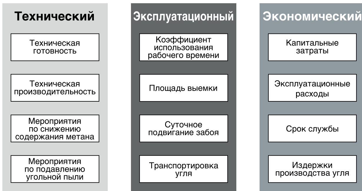
Рис. 3. Уровни сравнения комбайновой и струговой технологий производства угля
