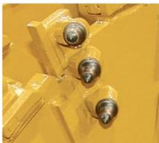
**Die Platzierung der Dreiergruppen-Fräswerkzeuge am Rotorende räumt loses Material weg und verringert den durch Rangieren in der Fräsbahn entstehenden Verschleiß am Rotor.**
