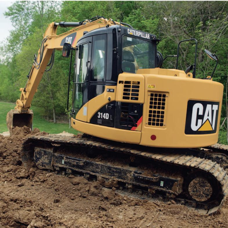
Caterpillar utiliza métodos avanzados de ingeniería y software para analizar todas las estructuras, creando una máquina fiable y duradera para las aplicaciones más rigurosas. Más del 70 por ciento de las soldaduras estructurales son robóticas y alcanzan una penetración adicional que supera a las de soldaduras manuales. Estos componentes estructurales y el tren de rodaje son la columna vertebral de la durabilidad de la máquina.
