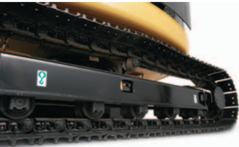
La máquina Cat 307D ofrece tres opciones de cadena diferentes, lo que permite lograr la configuración correcta de la máquina que se adapte al trabajo.
