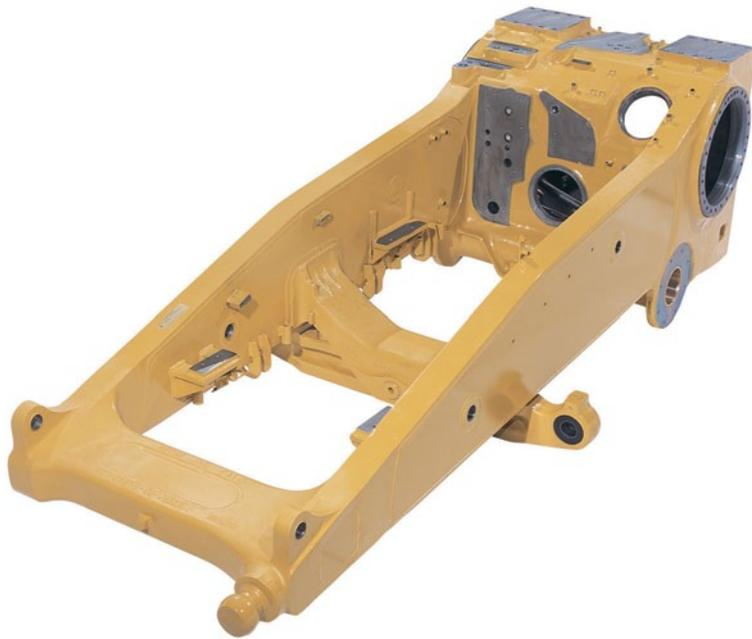
O chassi principal do D8T é construído com fundições reforçadas de aço líderes de mercado, trilhos da armação de seção totalmente em caixa e seções enroladas contínuas nos trilhos do chassi superior e inferior fornecem a resistência para absorver altas cargas de impacto e forças de torção.
