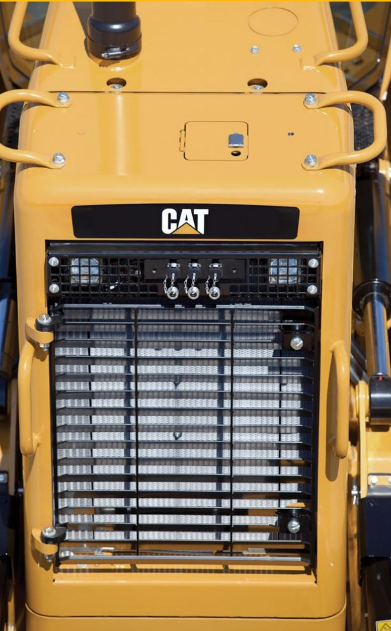
O radiador do motor, o pós-refrigerador ar-ar (ATAAC, Air To Air After Cooler) e o arrefecedor de óleo hidráulico estão agrupados num mesmo plano. A construção em placa com barras de alumínio contribui para a durabilidade e permite uma transferência de calor mais elevada, bem como uma resistência superior à corrosão. Os núcleos de série contêm 8,9 aletas por polegada (6,5 aletas por polegada na versão com gestão de resíduos) para permitir a passagem de detritos e reduzir as obstruções.
