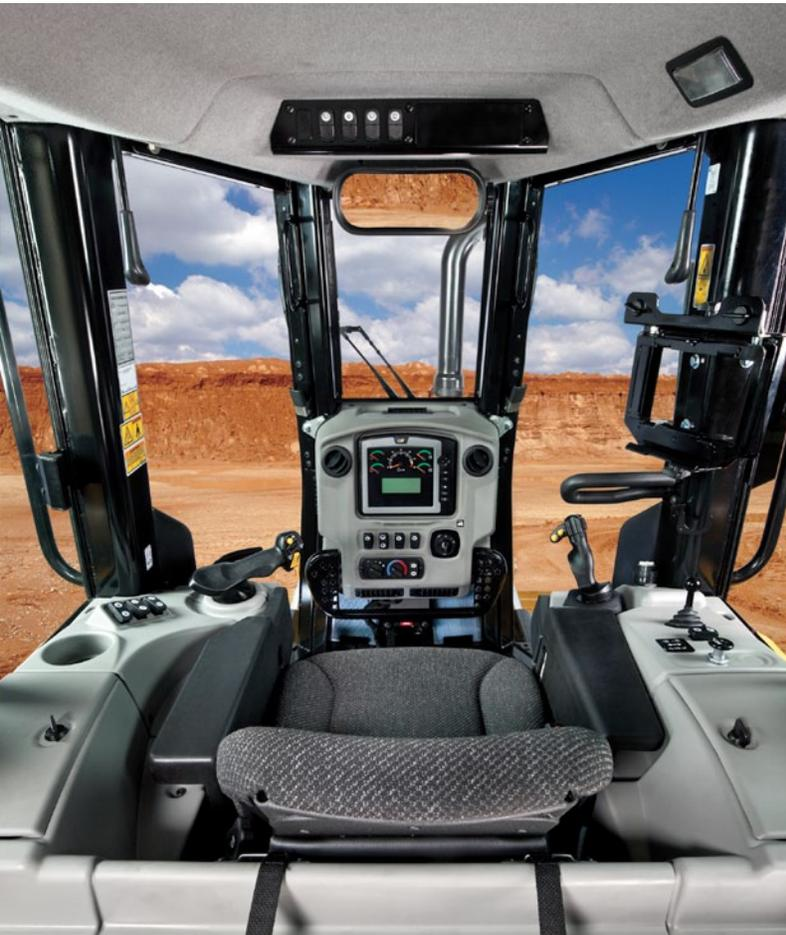
Uma cabina isolada e pressurizada reduz a infiltração de poeiras, o ruído e as vibrações. As vidraças de grandes dimensões oferecem excelente visibilidade. Os limpavidros intermitentes maximizam a visibilidade em condições meteorológicas adversas. A localização dos controlos do aquecimento e ar condicionado é muito prática. O controlo da temperatura é automático.
