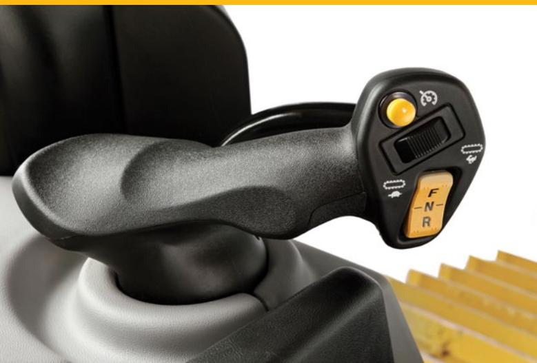
Todos os controlos são eletro-hidráulicos, o que significa precisão e manobrabilidade. O seu design é ergonómico para uma operação fácil, intuitiva, confortável e de baixo esforço. A resposta da lâmina pode ser regulada através do perfil do operador no visor.
