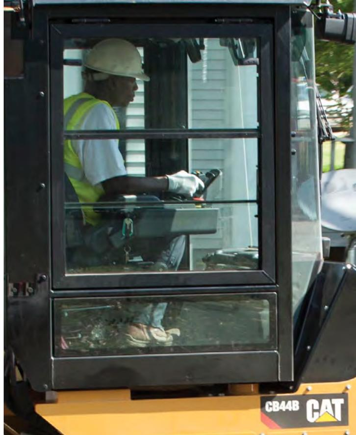
*Les consoles de commande Cat® sont intégrées dans les sièges pivotants, vous permettant ainsi d'avoir les commandes et l'affichage à portée de main.*
