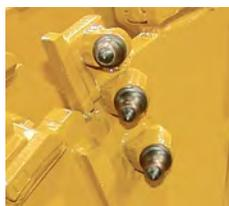
**Disposition des pics de coupe par trois et en éventail aux extrémités du rotor permettant d'éliminer les débris et de réduire l'usure du rotor lors de manœuvres pendant la coupe.**
