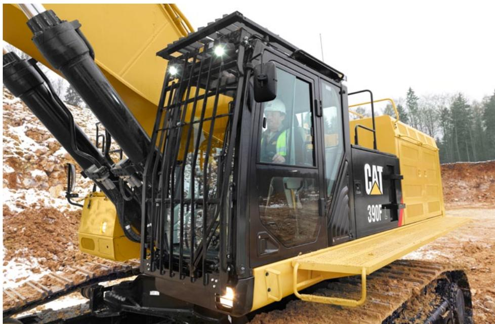
En option, le système de protection contre les chutes d'objets (FOGS) vous protège contre les débris susceptibles de percuter la cabine.
