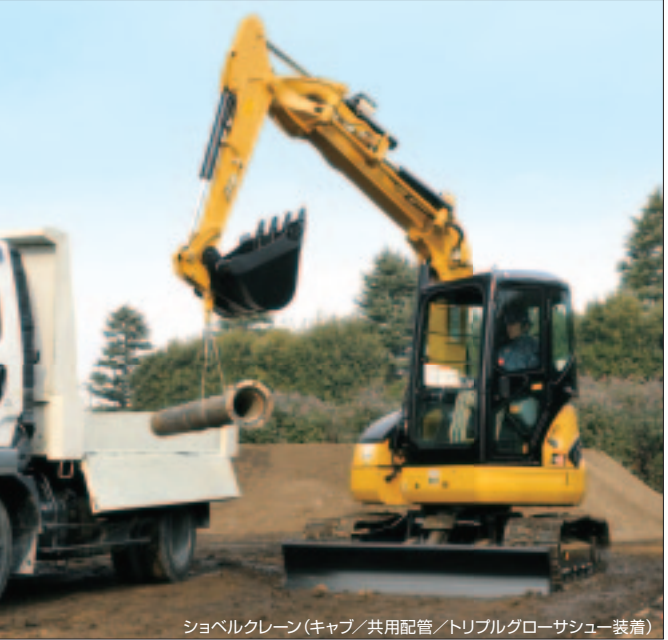
ショベルクレーン(キャブ/共用配管/トリプルグローサシュー装着)
