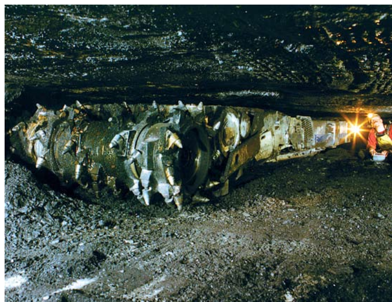
Комбайн CM210 во время работы в тонком пласте 860 мм
