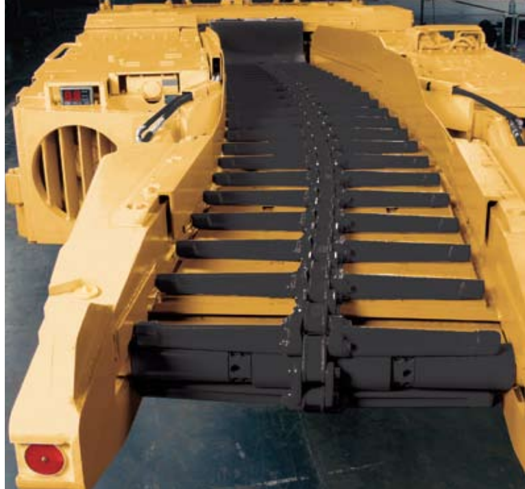
Разгрузочная стрела конвейера с автоматическим натяжным устройством цепи
