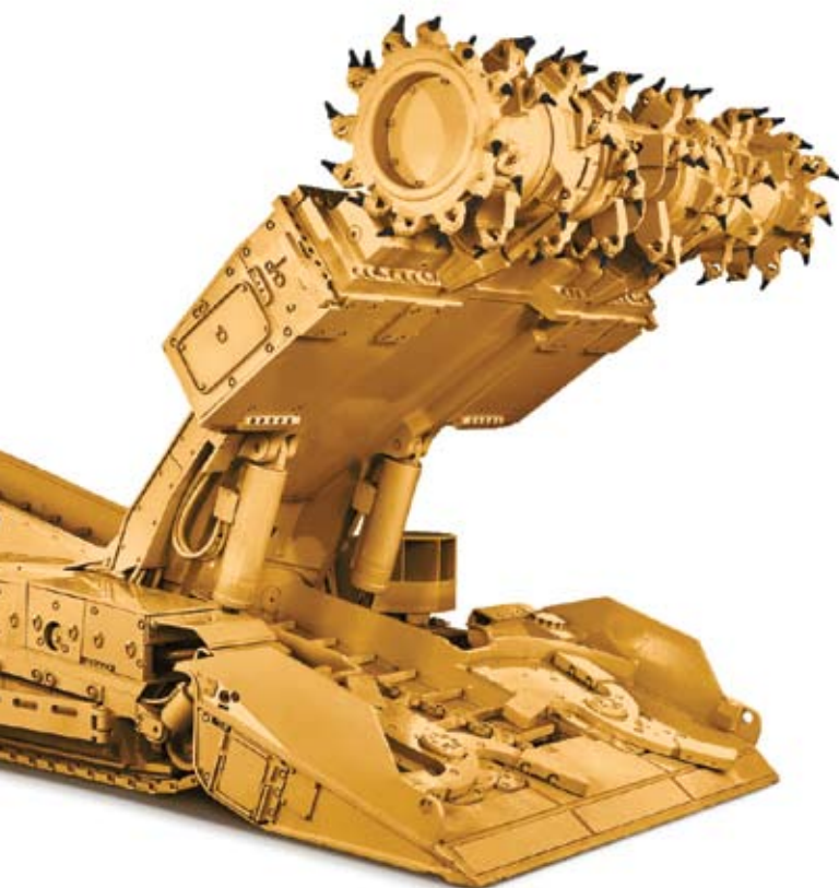
Быстрое изменение высоты режущих элементов
