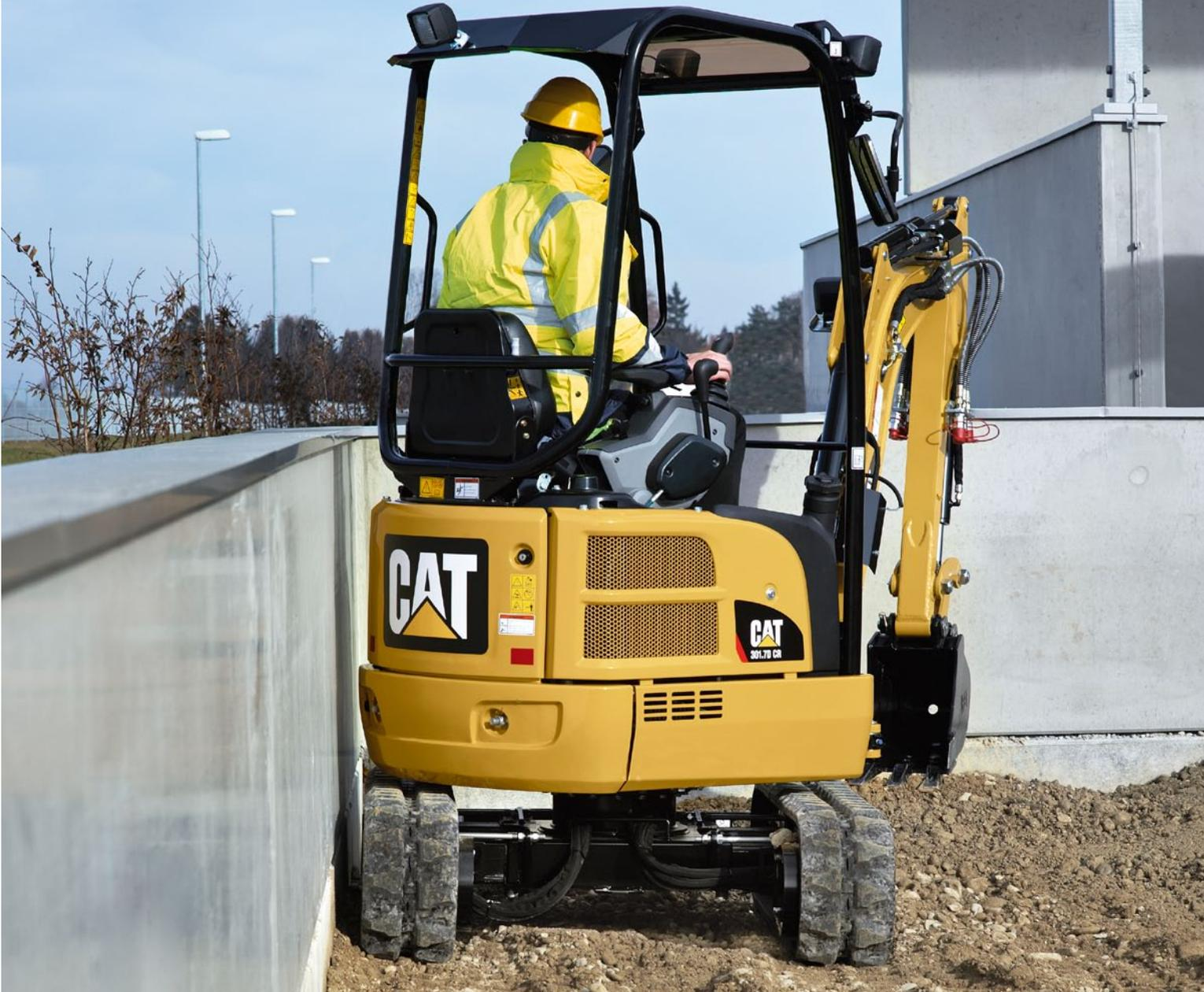
El giro de la cola cero del modelo Cat 301.7D CR permite trabajar cómodamente en espacios de trabajo reducidos, ya que el bastidor superior de la máquina es capaz de girar en el espacio de la anchura de su cadena. Este diseño de radio compacto también le permite concentrarse en el trabajo que está realizando sin tener que preocuparse por posibles daños en la parte trasera de la máquina o en el lugar de trabajo.
