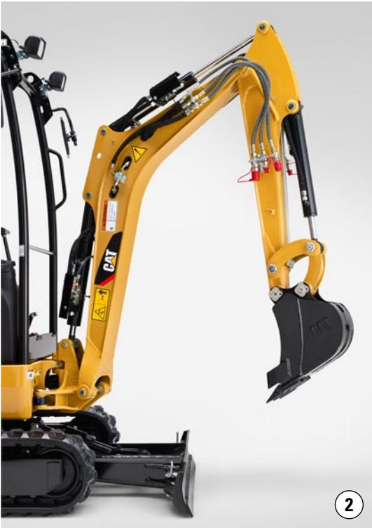
Las conexiones de desconexión rápida "listas para trabajar" están equipadas con un acumulador de serie para extraer y cambiar las herramientas de manera fácil y rápida. Al estar ubicadas cerca del implemento, reducen la longitud de la manguera y minimizan los posibles daños.
