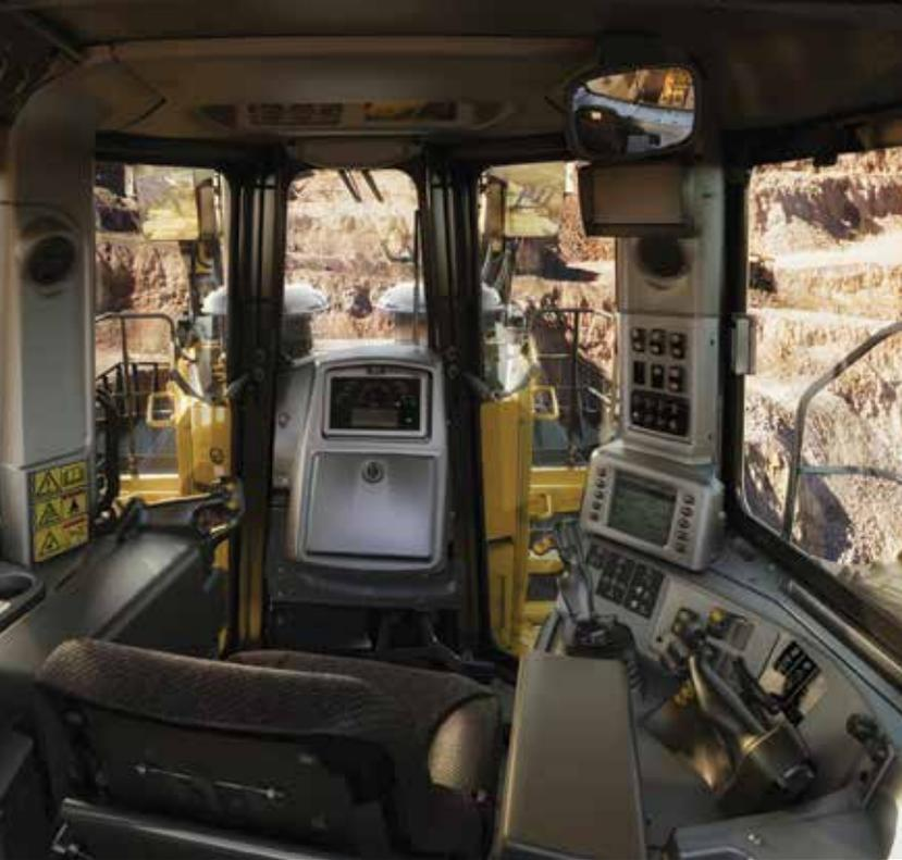
Cat T系列驾驶室专为提高操作员的舒适度、安全性和工作效率而设计，采用可缓解疲劳的人机工程学控制装置，增强了视野，并配有直观的监控系统和信息显示屏。其特点包括完全可调的空气悬浮座椅、降低的噪音水平以及自动气候控制系统。
