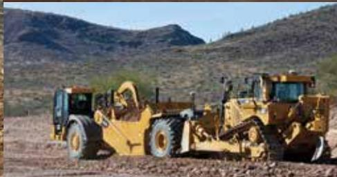
通用的Cat推土机能让矿场保持在巅峰生产效率下运营，并且是完成诸多作业必不可少的机器，例如卡车卸载和场地维护、爆破后采掘面整平、为采掘面建立通用坡度和宽度，以及与装载机、挖掘机和吊斗铲配合以支持装载和运输车队的绩效。
