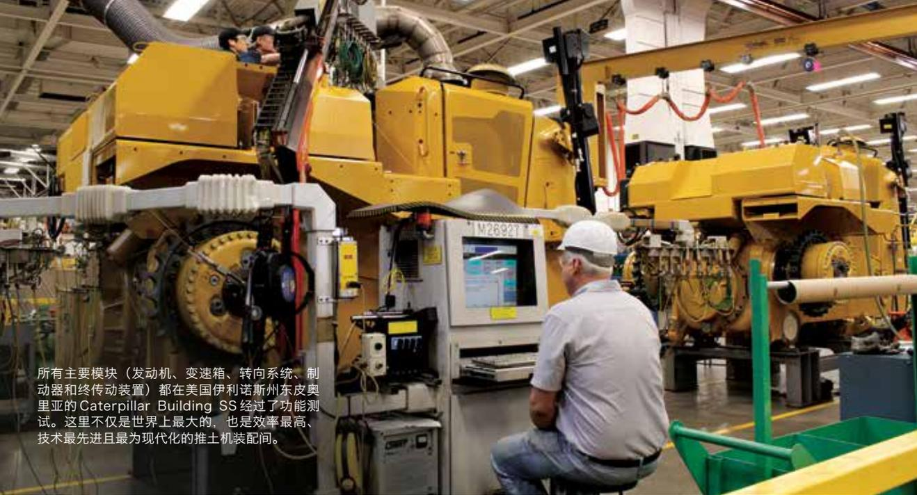
所有主要模块（发动机、变速箱、转向系统、制动器和终传动装置）都在美国伊利诺斯州东皮奥里亚的 Caterpillar Building SS 经过了功能测试。这里不仅是世界上最大的，也是效率最高、技术最先进且最为现代化的推土机装配间。
