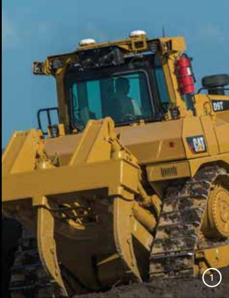
1. Cat 坡度控制 3D 利用安装了双 ROPS 的 GNSS 天线和缸内位置传感器提供精准的铲刀定位，无需在铲刀上安装钻桅和电缆。该系统还能减少对坡度标桩和坡度检查的需要；因此这会减少作业场地所需的人员数量，从而降低人员成本并提高安全性。
