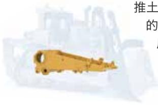
推土机的主体部分是一个结实耐用的重型机架，该机架采用了高强度钢铸件以及连轧成型的顶部和底部车架纵梁。机架能为底盘、高架终传动和其他部件提供牢固的支撑。
