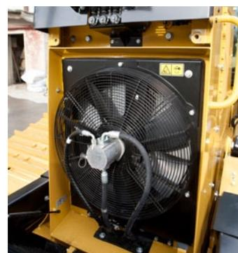
Le radiateur du moteur, le refroidisseur d'admission air-air (ATAAC) et le refroidisseur d'huile hydraulique sont regroupés en un seul ensemble. La structure à plaques et barres d'aluminium apporte une meilleure longévité, une résistance accrue à la corrosion et un excellent transfert de chaleur.
