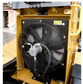
El radiador del motor, el posenfriador aire a aire (ATAAC, Air To Air After Cooler) y el enfriador de aceite hidráulico están empaquetados en un plano sencillo. La construcción de la placa de barra de aluminio proporciona durabilidad y permite una mayor transferencia de calor y una resistencia a la corrosión superior.
