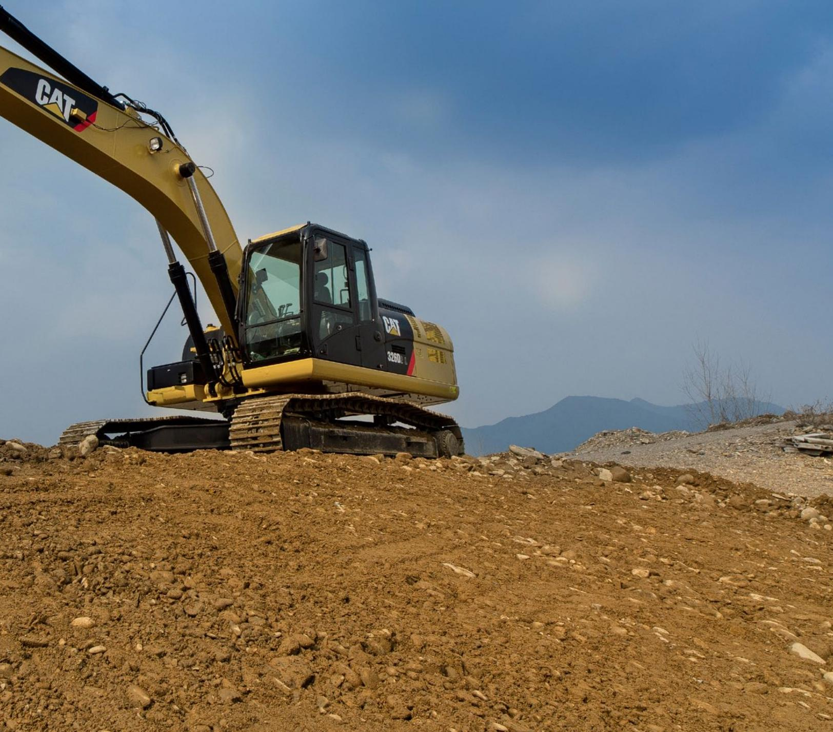
**Le modèle 326D2/D2 L intègre de nombreuses innovations destinées à améliorer votre efficacité sur les chantiers grâce à une réduction des coûts d'exploitation, à d'excellentes performances et à une polyvalence élevée. La consommation de carburant est réduite de 9 % par rapport au modèle antérieur.**
