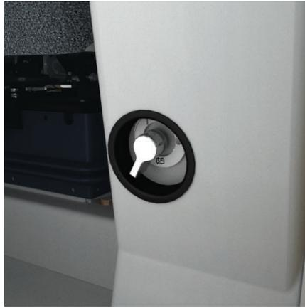
**Interruptor de desconexión remoto.** El interruptor de desconexión remoto, alojado en la cabina, está conectado en serie con el interruptor de desconexión estándar de la máquina. El interruptor, ubicado en el lado izquierdo del asiento del operador a la altura de la rodilla, permite al operador acceder rápidamente a la desconexión.
