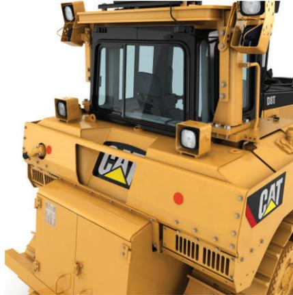
**Protectores del tanque hidráulico y del tanque de combustible.** Los protectores hidráulicos y de combustible protegen el tanque de aceite hidráulico del implemento, la caja de baterías y el tanque de combustible.
