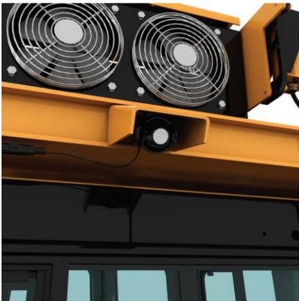
**Cámara de visión trasera.** Un accesorio de cámara de visión trasera WAVS está disponible para proporcionar visibilidad adicional a los espejos estándar.
