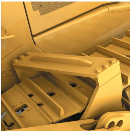
**Barras deflectoras delanteras.** El diseño angulado de las barras deflectoras delanteras evita que los residuos se adhieran a las cadenas y dañen los guardabarros o los tanques hidráulico y de combustible.
