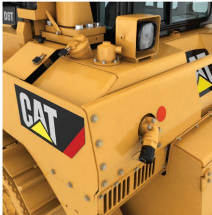
**Sistema de llenado rápido de combustible.** El sistema optativo de llenado rápido de combustible, con corte de combustible para evitar derrames, puede disminuir el tiempo de inactividad.
