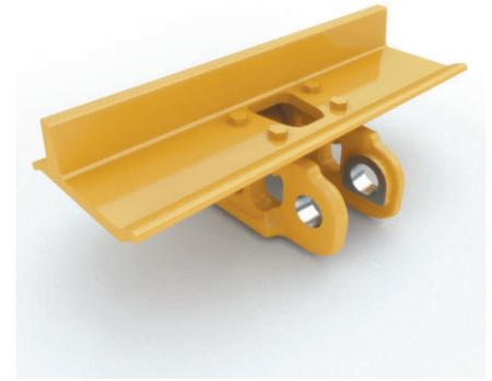
**Zapatas de cadena con orificio trapecial.** Las zapatas de cadena con orificio trapecial disminuyen la compactación en las cadenas, el agarrotamiento de las cadenas y el desgaste acelerado de los pasadores y de los bujes. Los orificios trapeciales alivian la compactación al permitir que la rueda motriz expulse la suciedad y los residuos.
