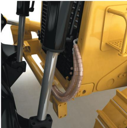
**Protectores de las tuberías del cilindro de inclinación.** Los protectores de las tuberías del cilindro de inclinación evitan el daño por contacto de las tuberías y mantienen la flexibilidad de las mangueras.
