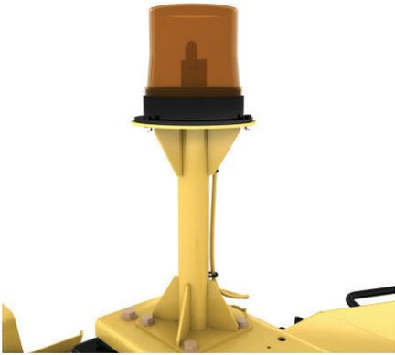
**Luz de baliza.** La unidad de baliza estroboscópica Federal Signal Pulsator 551 de destello sencillo (5 julios) de servicio pesado es impermeable y resistente a la intemperie y tiene el suministro de corriente encapsulado en una sustancia gelatinosa. La baliza está cableada directamente y sólo puede apagarse con el interruptor de desconexión. Se eleva por encima de la parte más alta de la máquina a fin de mejorar la visibilidad.
