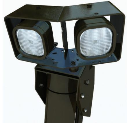
**Luces suplementarias montadas en el cilindro.** Las luces suplementarias montadas en el cilindro (cuatro delanteras) se han trasladado de las aberturas de los guardabarros a la parte superior de los cilindros. Las aberturas de los guardabarros se cubren con planchas para evitar la penetración de residuos. Se puede seleccionar luz de halógeno o tipo HID (alta intensidad).
