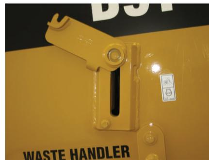
**Ranuras de limpieza.** Están disponibles ranuras de limpieza para mantener el núcleo del radiador libre de residuos. Las máquinas equipadas con ranuras de limpieza se pueden limpiar manualmente para mantener su máquina operando sin problemas.
