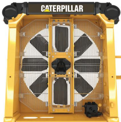
**Ventilador hidráulico reversible.** El sistema invierte automáticamente el giro del ventilador a intervalos configurados para purgar los residuos del compartimiento del radiador y del motor. El operador puede purgar manualmente el sistema en cualquier momento. El ventilador es controlado por el módulo de control electrónico del motor.
