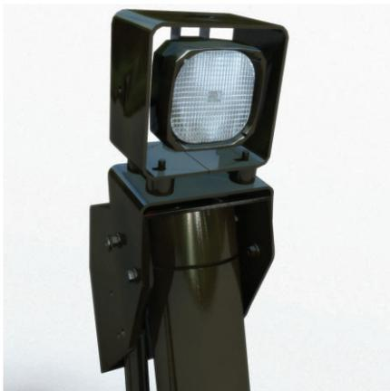
**Luces delanteras.** Las luces delanteras están montadas en la parte superior de los cilindros de levantamiento de la hoja topadora, lo que les permite proyectar la luz por encima de la rejilla para basura y las mantiene por encima del entorno de residuos concentrados para prolongar su vida útil.
