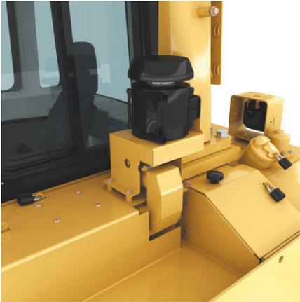
**Cabina mejorada.** La cabina mejorada provee mayor presurización de la cabina para obtener mejor calidad de aire en aplicaciones sujetas a mucho residuo. Incluye un antefiltro impulsado, con un filtro de alta eficiencia, lo cual disminuye los intervalos de mantenimiento del sistema.
