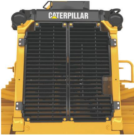
**Protector del radiador.** El protector abisagrado de servicio pesado del radiador protege el sistema de enfriamiento.
