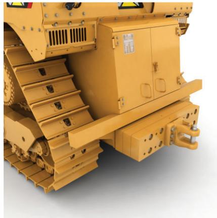
**Barras deflectoras traseras.** Las barras deflectoras traseras incorporan una barra de tiro rígida y una caja con puertas de acceso grandes para almacenamiento en las máquinas no equipadas con desgarradores. Las barras deflectoras traseras están listas para la instalación del contrapeso en caso de que se necesite añadir peso en la parte trasera. En las máquinas con desgarradores, las barras deflectoras se montan en el bastidor del desgarrador.
