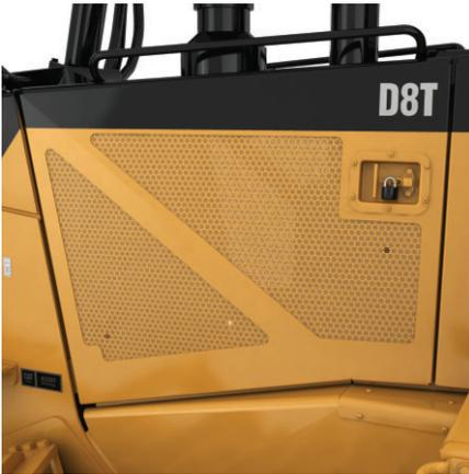
**Recintos del motor.** Los recintos del motor incluyen capó y paneles laterales perforados. Los recintos evitan que los materiales arrastrados por el aire penetren en el compartimiento del motor y disminuyen el taponamiento del radiador, lo cual puede causar problemas en el sistema de enfriamiento.
