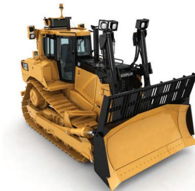
**Capó, cilindros y parte posterior de la hoja pintados de negro.** El capó, los cilindros y la parte posterior de la hoja se pintan de negro para reducir el reflejo de las luces cuando se opera de noche o con luz directa del sol.
