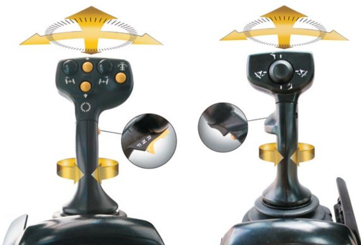
Las dos palancas universales electrohidráulicas permiten a los operadores sentirse más cómodos y ser más productivos. Los módulos de control regulables electrónicamente ayudan a ubicar a los operadores para obtener visibilidad óptima y operación adecuada.
