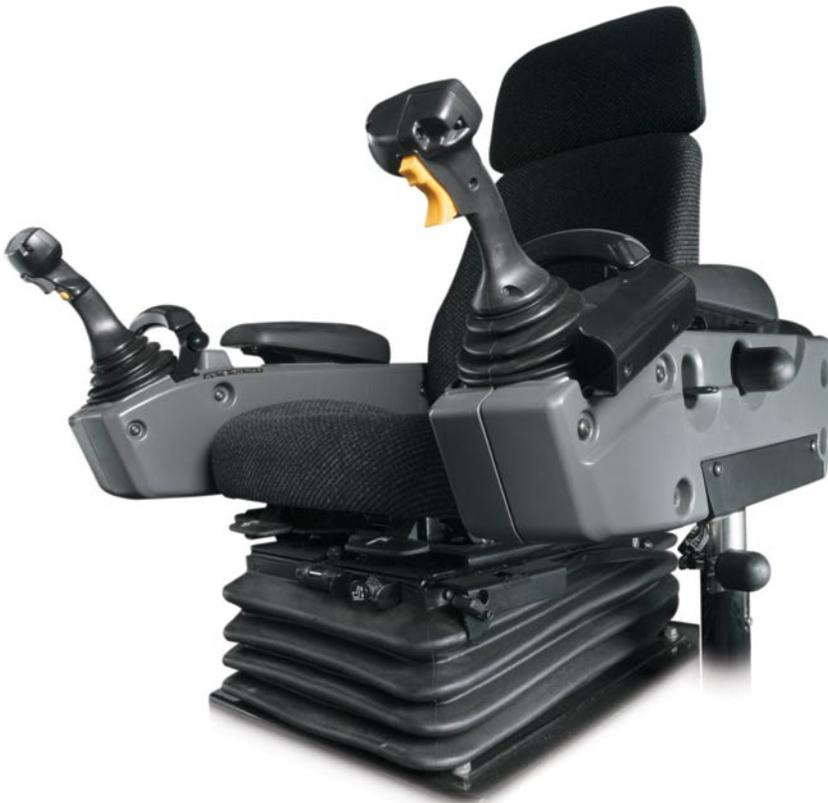
Os operadores sentem-se mais confortáveis e produtivos com dois joysticks eletro-hidráulicos. Em todo o mundo, operadores novos e experientes relatam que os controles são de fácil aprendizado e que os novos suportes de controle com ajuste eletrônico ajudam a posicioná-los para obter mais conforto, visibilidade e operação adequada.
