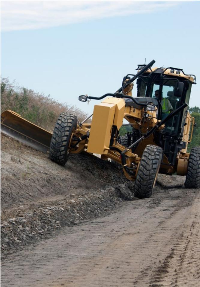
Se você trabalha em condições de solo fofo, onde a tração pode ser um desafio, a AWD opcional pode proporcionar potência adicional para o solo que precisa ser trabalhado com mais eficiência na lama, no cascalho, na areia ou na neve. A tração adicional reduz o deslizamento em encostas.
