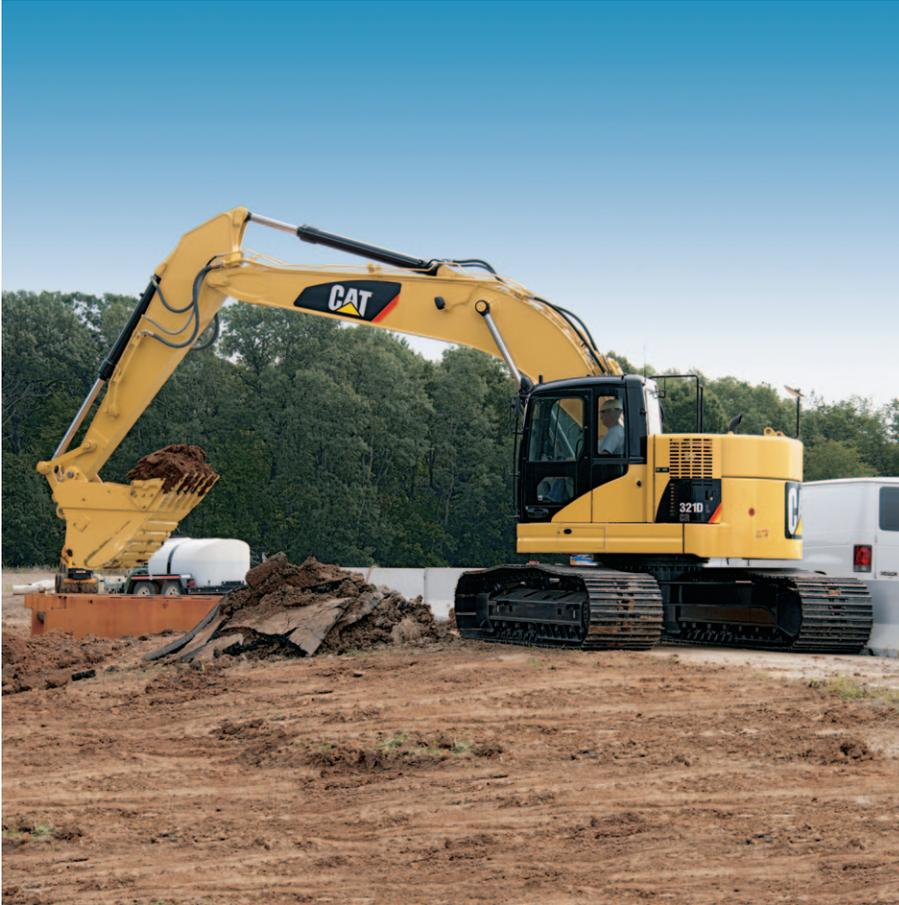
**Raio Compacto.** A 321D LCR possui um design de raio compacto que a torna ideal para trabalhar em espaços restritos como, por exemplo: próxima a prédios, construções de estradas – pistas fechadas e estradas em locais de extração de madeira. O raio de giro da traseira é de apenas 1,68 m (5'6") comparados a 2,75 m (9'0") da 320D. Ao ser girada a 90 graus e trabalhar na lateral, uma quantidade mínima de contrapeso se estende além da largura da esteira.
