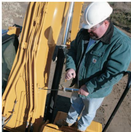
**Pontos de Lubrificação.** Um bloco de lubrificação remota concentrada na lança fornece graxa a locais difíceis de alcançar na parte da frente.
