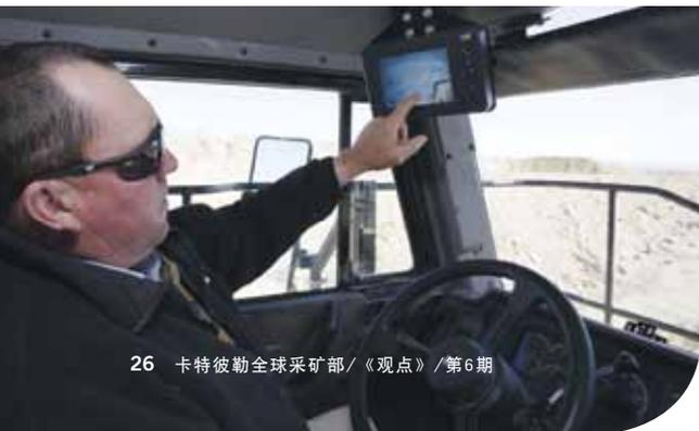
到7米/23英尺)，中等距离雷达（最远可探测到20米/66英尺），以及机器前侧、后侧和两侧摄像头。
