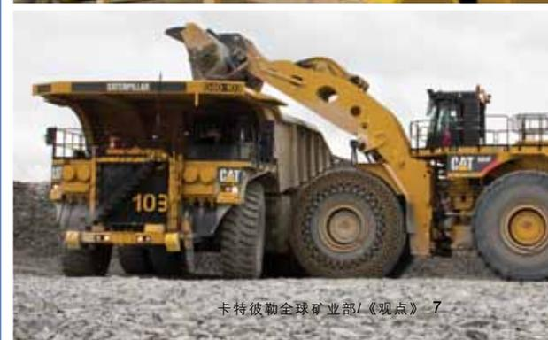
奥西斯科为它的新型卡特® 994F 轮式装载机购买的加长臂高举升连杆机构可以多提供1075毫米（42英寸）的卸载高度，从而更加高效地装载它的793F卡车。
