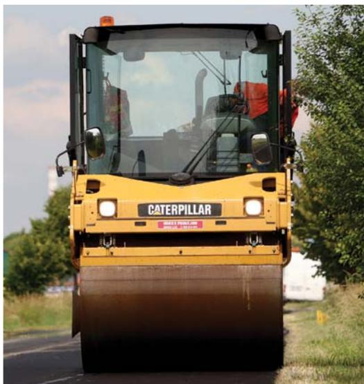
especificados foram obtidos com calcadores vibratórios na barra de alisamento da pavimentadora o que foi seguido pela compactação com um rolo vibratório Cat CD534B com um peso de 12 toneladas. O trabalho todo foi concluído em tempo e tanto a lisura da superfície como os objectivos de qualidade foram satisfeitos.
