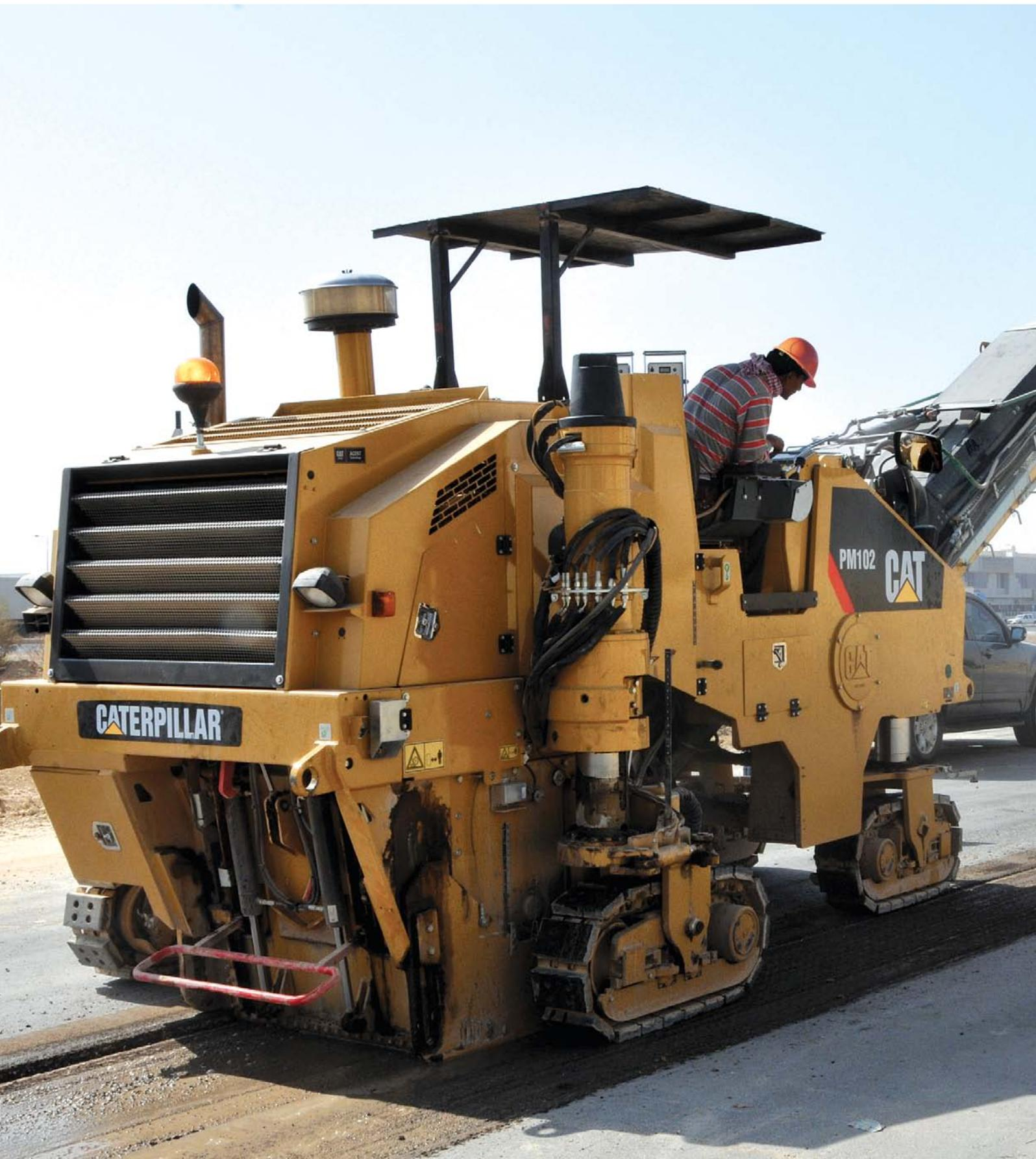
^ El proyecto consistía en la retirada de una capa de asfalto de la calzada para el tendido de tuberías.
