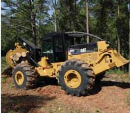
**Construction caissonnée.** La structure caissonnée conçue et fabriquée par Caterpillar établit la norme du secteur en matière de châssis principaux fiables et durables. Le 525C est le fruit d'analyses informatiques et d'essais poussés sur le terrain.
