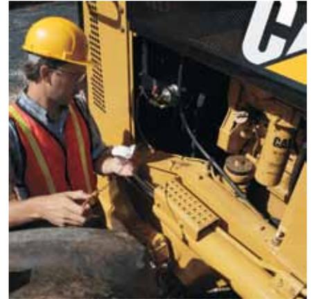
**Circuit électrique.** Le circuit électrique 24 V offre une alimentation électrique fiable pour le démarrage du moteur, les éclairages et les diagnostics moteur. Les circuits de câblage sont colorés, numérotés et protégés par des disjoncteurs.
