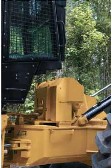
**Treuil hydraulique.** Le 525C est équipé d'un-treuil hydraulique à commande électronique pour l'utilisation de grappins, qui remplace le treuil mécanique. Le treuil hydraulique assouplit l'utilisation en permettant d'exploiter l'effort de traction pendant le treuillage et en supprimant la rotation constante de l'arbre de transmission.
