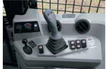
**Fonction Auto-Grab.** La fonction Auto-Grab de Caterpillar permet de surveiller et de régler constamment la pression de la pince en fonction des besoins afin de tenir fermement la charge du grappin lors du débardage. Elle s'active sans difficulté, à la demande, grâce à un contacteur situé sur le levier de commande côté droit.
