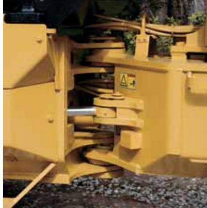
**Articulation.** La section centrale extra-robuste est équipée de plaques et de bossages surdimensionnés permettant de dissiper les forces. Un grand roulement à double rouleau conique est utilisé sur l'articulation inférieure afin de réduire les contraintes de flexion et de maintenir des joints étanches.
