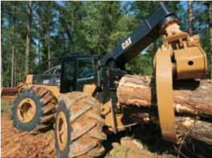
**Grappins fiables et productifs.** Pour une longévité optimale, Caterpillar a conçu des grappins avec construction caissonnée. La courbure de la pince accélère le groupage des charges, tandis que la force de serrage accrue assure une parfaite rétention de la charge pendant le déchargement.
