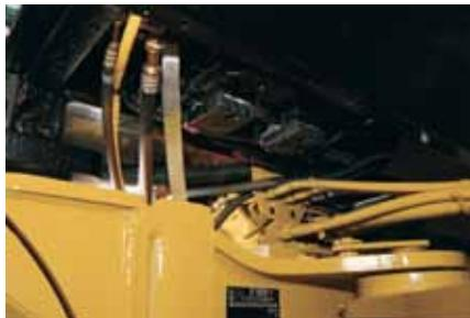
**Flexibles d'articulation.** Les conduites de pilotage des grappins, les conduites de pression et de détection de charge sont acheminées par-dessus l'articulation et cloisonnées pour faciliter le remplacement des flexibles et l'entretien. Les flexibles d'articulation bénéficient de la technologie ToughGuard<sup>TM</sup> Cat et sont très résistants à l'usure.
