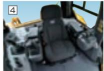
着座感知センサにより、オペレータが不在の時は走行および作業装置の制御システムが無効になる安全設計です。
