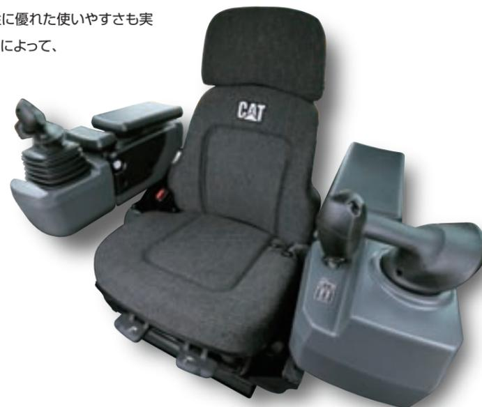
ステアリング、作業機レバーユニットおよび左右アームレスト一体型のエアサスペンションシートを標準装備。体重調整や多段階リクライニング&サスペンション機能など、長時間座り続けても疲れの少ない快適性を実現します。
