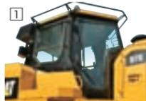
ROPS (転倒時運転者保護構造)およびFOPS (落下物保護構造)を装備。
