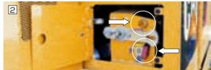
高電圧コンポーネントにアクセスする場合、危険電圧表示ランプを確認して安全が否かをチェックする事ができます。
