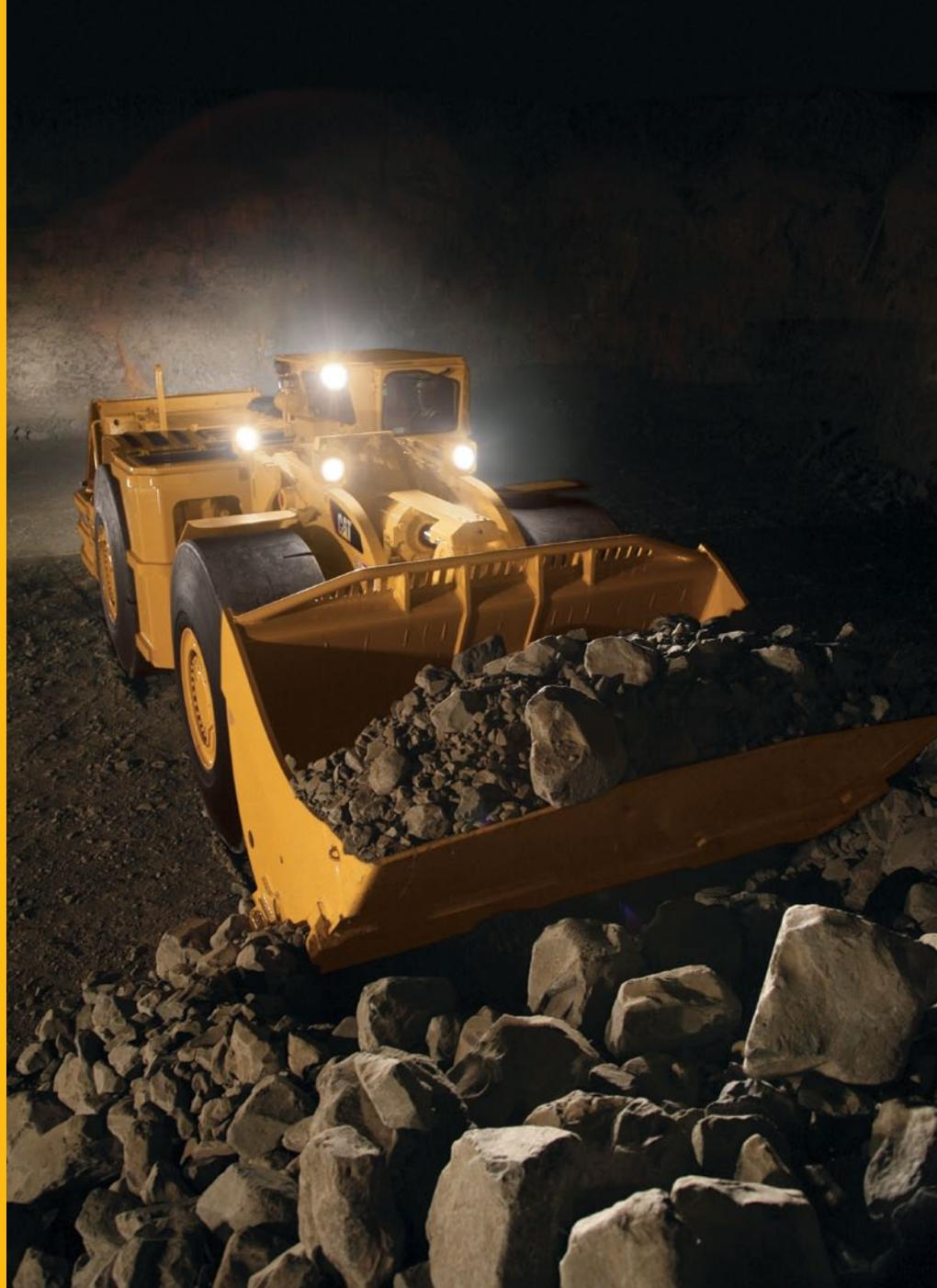
R2900G 井下矿运机专为井下采矿场合提高生产率、降低每吨物料装载和运输成本而设计。它具有紧凑的设计，灵活的性能，坚固的结构和方便的保养，从而确保出色的生产效率、长久的寿命和低廉的营运成本。
