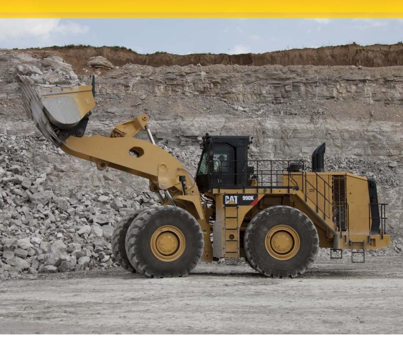
Modelo de motorCat® C27 ACERT™EmisionesTier 4 Final de la EPA de EE. UU.,<br/>equivalente a Tier 2Potencia bruta (ISO 14396)561 kW752 hpPotencia neta: SAE J1349521 kW699 hp
