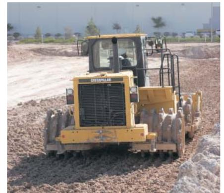
**刮土板。**无论向哪个方向滚压，都可避免碾轮携带污垢。直通螺栓设计可使维修保养更方便。
