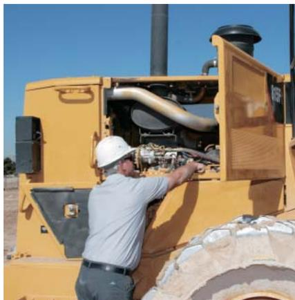
**右侧检修门。**将燃油滤清器、油水分离器、燃油起动加油器和发动机油尺放在便于操作的位置。
