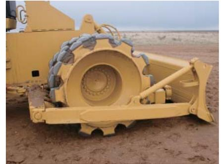
**外部安装的直铲。**经过热处理的刮土板以及 DH-2™ 钢制铲刃和端刃等若干箱形结构可延长铲刀寿命。外部安装使设计更坚固，因为应力施加在车架上而不是铲刀上，因此会减少铲刀屈挠。与内部安装设计相比，压实深度更深，并可使用更宽的铲刀。
