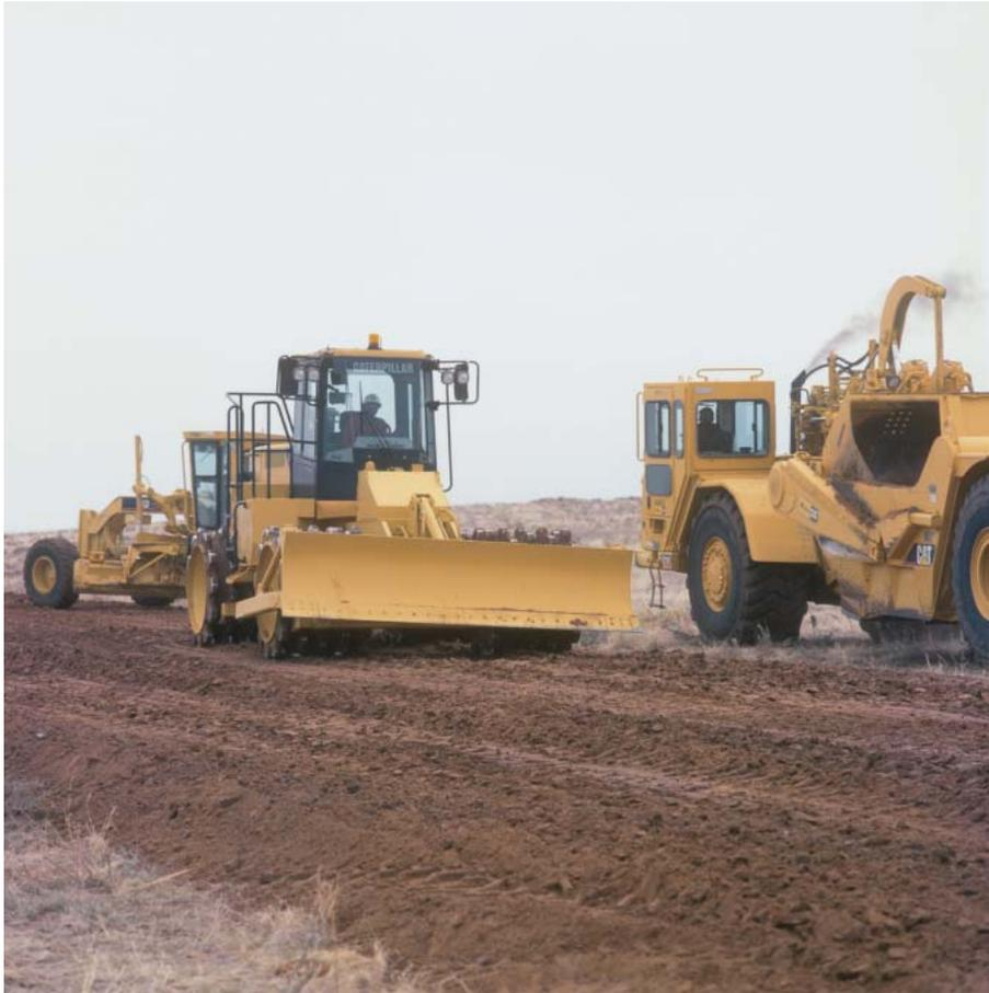
**铲刀套件。**包括铲刀、主推臂、耳轴安装件、有可更换耐磨板且与推土机等长的防滑板、可反转铲刃、有自磨功能的端刃、液压管线护罩和液压提升气缸。
