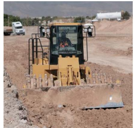
**应用。**815F 系列 2 型在压实、摊铺、回填和推进铲运机等方面表现尤为突出。由于工作速度比其他类型的土壤压实机更快，815F 系列 2 型可以跟上快速行驶的铲运机车队或铰接式卡车的运输速度。在强调土壤压实机的速度和推土能力的作业中，815F 系列 2 型在所有同类产品中最首屈一指。
