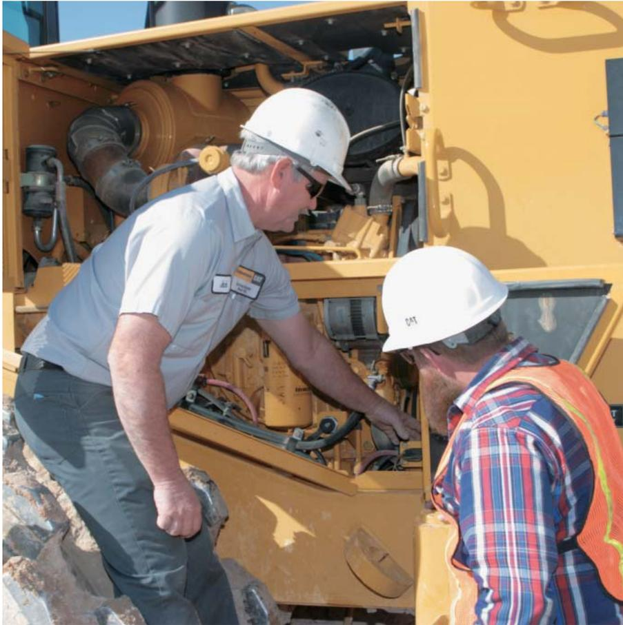
**发动机检修门。**发动机的全金属外壳和铰接检修门便于日常维护和检查。
