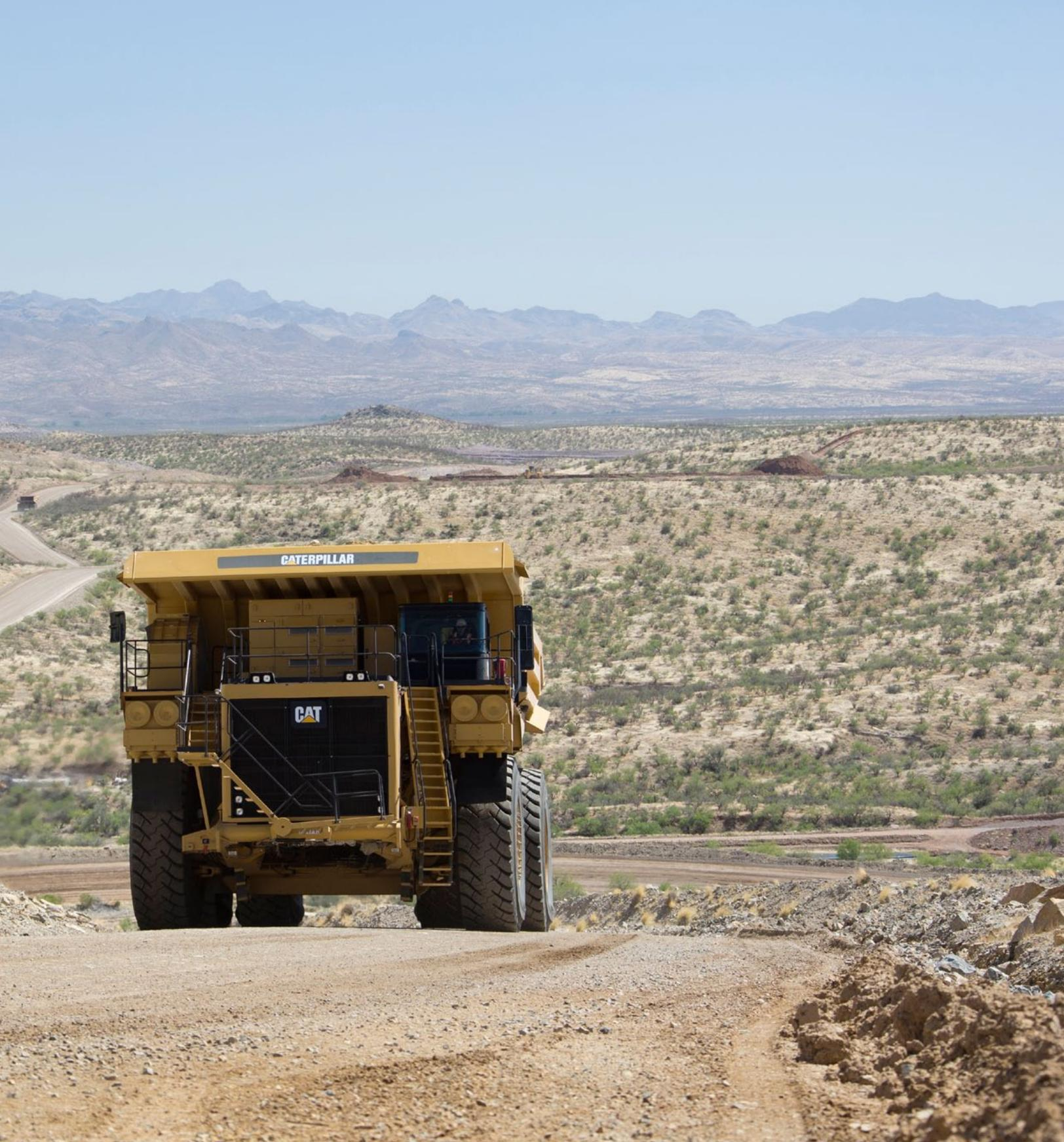
***Cat MT4400D AC 可提供可靠性、维修保养方便性以及较低的拥有成本和运营成本。这种卡车的全部零部件由一家制造商提供，并配有 Cat 3516C HD 发动机和 Cat 交流传动系统。***
