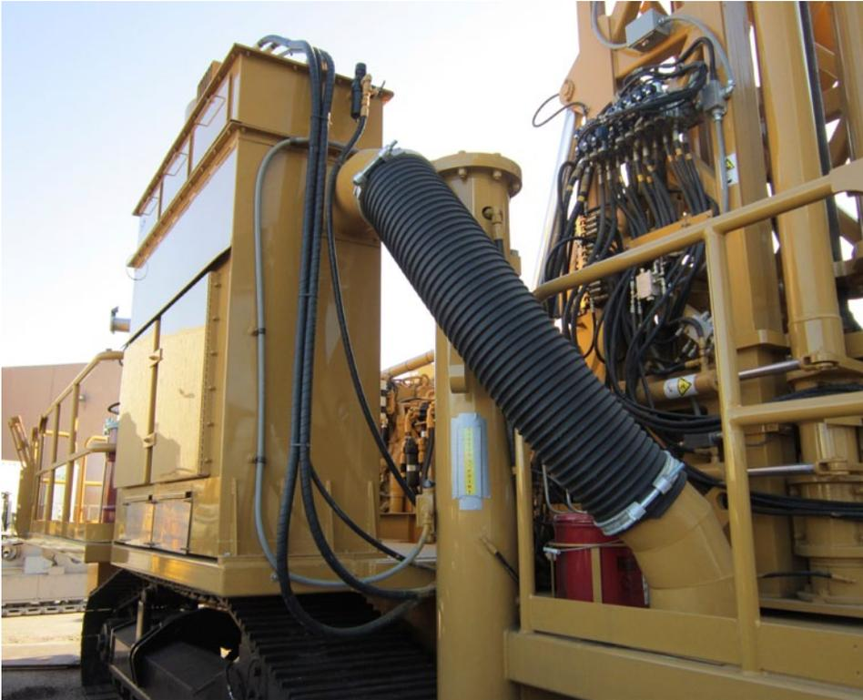
Para la recolección eficiente de polvo, el modelo MD6240 tiene un recolector de polvo nominal a 127 m<sup>3</sup>/min (4.500 pie<sup>3</sup>/min) y un sistema separado de inyección de agua. Los sistemas de inyección seca y de inyección de agua se pueden montar en la misma perforadora.
