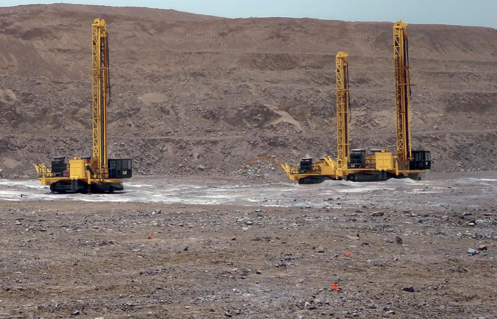
**Con la Perforadora Giratoria MD6240 obtiene alta productividad y bajos costos de propiedad. Con la fuerza de carga de la broca de 24.000 kg (52.911 lb) y la capacidad de profundidades de perforación de hasta 55,47 m (182'), el modelo MD6240 está bien equipado para perforar en aplicaciones para rocas duras o blandas. Construida para ser confiable, segura y de fácil servicio durante los años por venir.**
