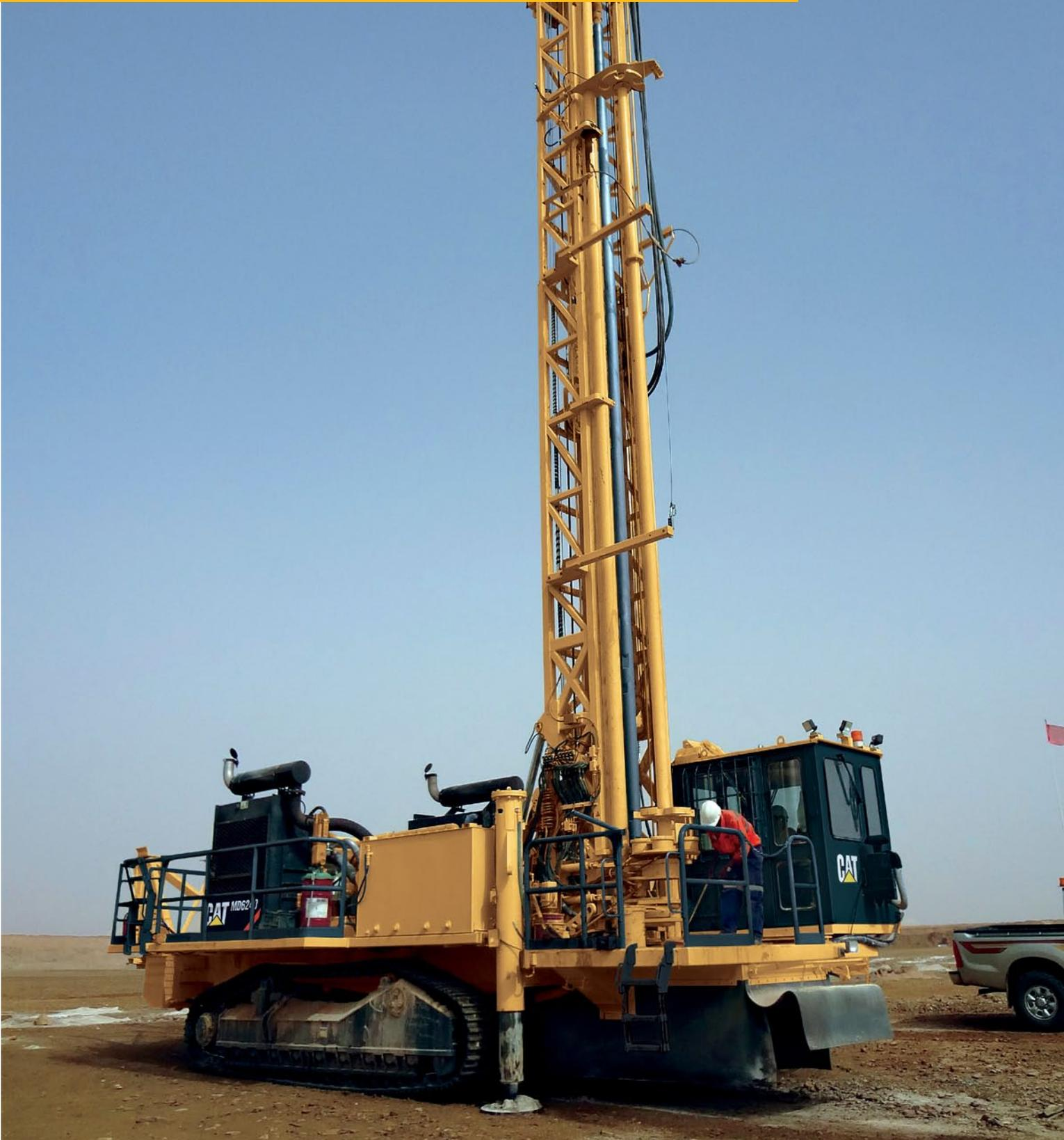
De construcción óptima para vida útil prolongada, el modelo MD6240 tiene estructuras de servicio pesado. El mástil, bastidor integral en A y bastidor principal son duraderos al proporcionar una plataforma resistente necesaria para la perforación en condiciones difíciles. El modelo MD6240 está equipado para rendir en ambientes desafiantes y proporciona alta disponibilidad, produciendo un impacto positivo en el resultado final.
