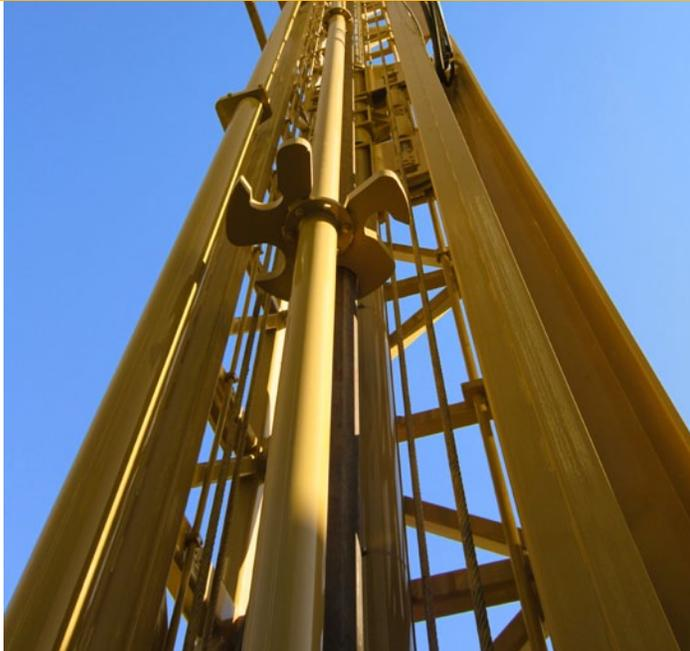
Para garantir a vida útil prolongada, todas as estruturas do mastro são projetadas com correia de corte duplo em áreas de alta tensão. Há várias opções de mastros para aplicações específicas.
