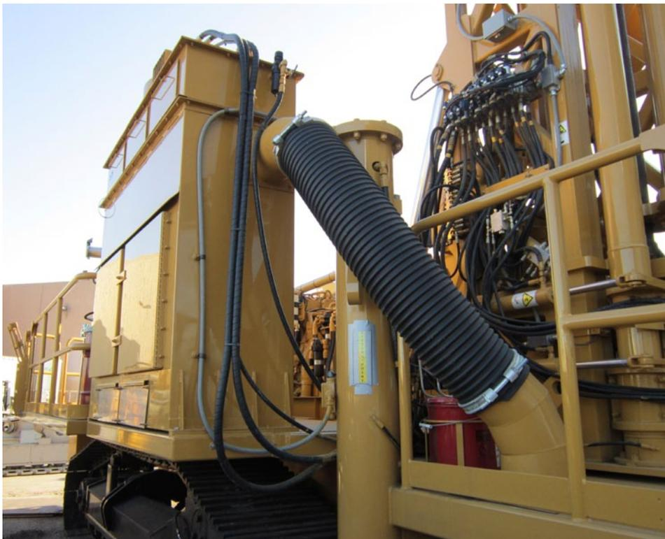
Para uma coleta de poeira eficiente, a MD6240 dispõe de um coletor de poeira classificado em 127 m<sup>3</sup>/min (4.500 pés<sup>3</sup>/min) e de um sistema de injeção de água separado. Ambos os sistemas de injeção de água e a seco podem ser instalados na mesma perfuratriz.
