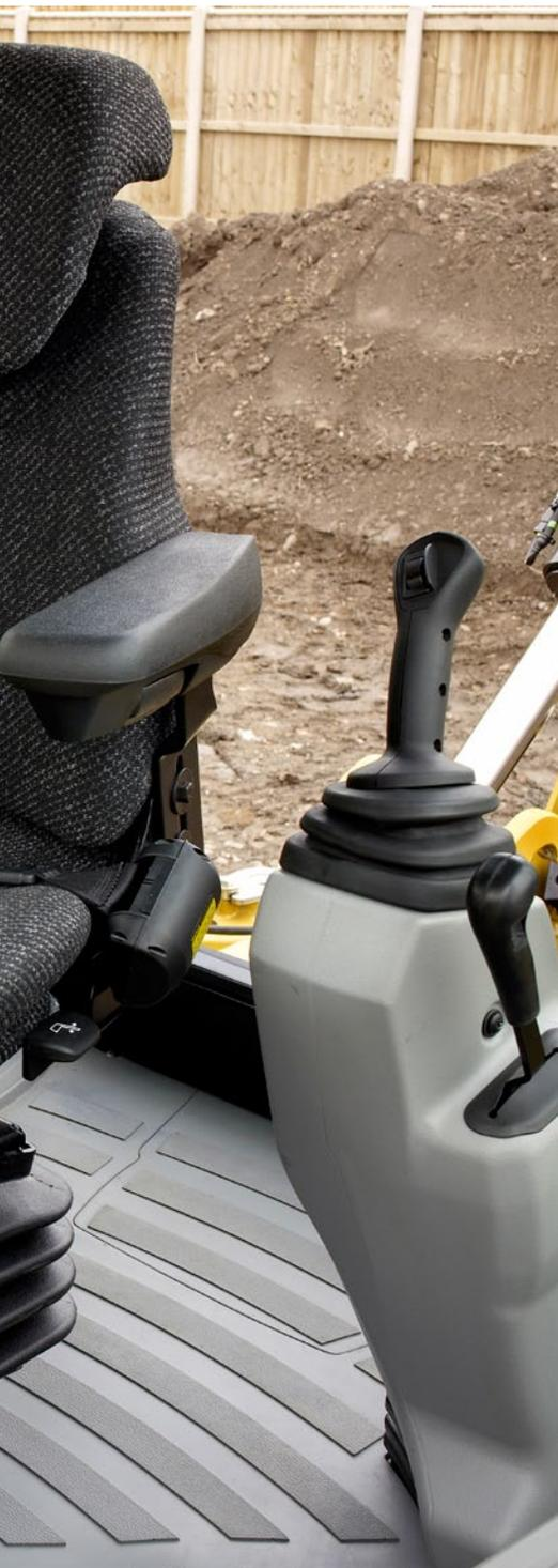
El operador cuenta con un interior espacioso y con estilo moderno que le proporciona comodidad y facilidad de operación para satisfacer las demandas más exigentes. El ancho de la cabina facilita girar, sin obstrucciones, desde el lado de la cargadora al lado de la retroexcavadora. La comodidad se incrementa con el asiento con suspensión neumática Cat de primera clase, lo que reduce la fatiga del cuerpo durante las largas jornadas de trabajo.
