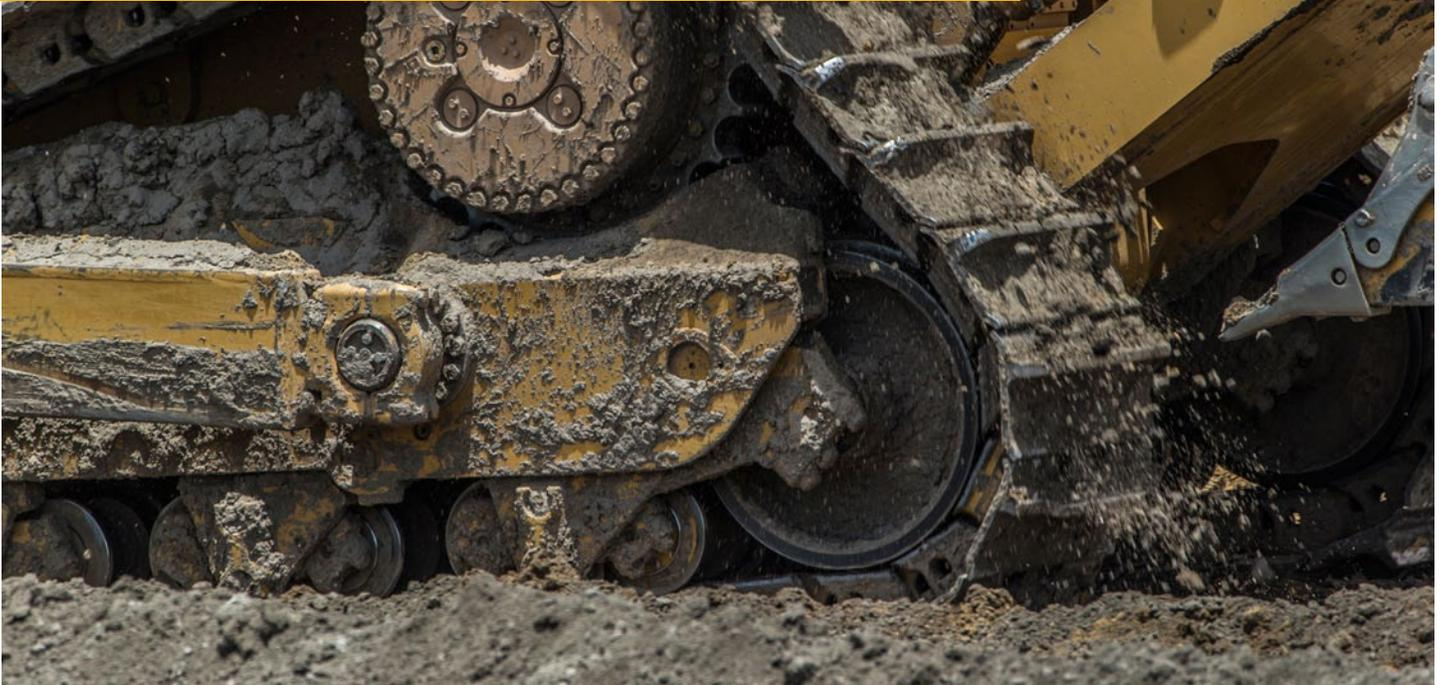
Sprocket yang ditinggikan dan undercarriage bersuspensi bekerja sama untuk meningkatkan traksi sambil menyediakan pengendalian yang mulus untuk operator Anda. Desain sprocket yang ditinggikan menyalurkan beban kejut implement ke rangka utama, sehingga final drive, poros, dan komponen kemudi terlindung dari guncangan keras. Keuntungan ini berarti produksi yang lebih tinggi dan umur komponen yang lebih lama.
