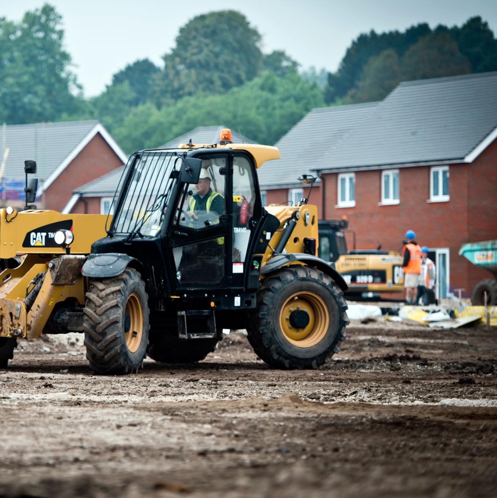
**Die Telehandler der Baureihe C verfügen über einen neuen Motor, der die Emissionsvorschriften gemäß EU-Stufe IIIB (EPA Tier 4 Interim) erfüllt, und über ein neues Lastschaltgetriebe, mit dem der Fahrer leicht das richtige Übersetzungsverhältnis für die jeweilige Arbeit auswählen kann.**
