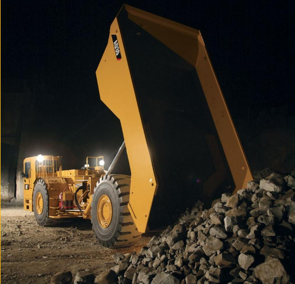
**Самосвал AD30 с шарнирно-сочлененной рамой для подземных работ разрабатывался для поддержания высокой производительности и снижения удельной себестоимости перевозки материала при выполнении небольших объемов подземных горных работ. Благодаря прочной, надежной конструкции и простоте обслуживания увеличивается срок службы машины и сокращаются эксплуатационные затраты.**
