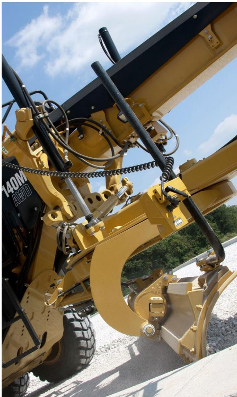
Caterpillar diseña los componentes de la barra de tiro y bastidor de la motoniveladora con el objetivo de asegurar el rendimiento y la duración. La corona de acero forjado de una sola pieza soporta cargas de gran esfuerzo y el sistema de protección contra el desgaste contribuye a reducir los tiempos de servicio y mantener los costes bajos.
