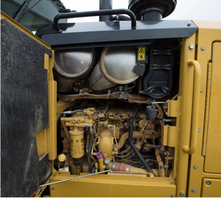
La tecnología de reducción de emisiones de la motoniveladora de la serie M 3 se ha diseñado para la comodidad plena del operador ya que no se requiere acción ninguna por su parte. No hay necesidad de detenerla. La regeneración se realiza automáticamente en arranque frío y, si es necesario, en segundo plano mientras trabaja.
