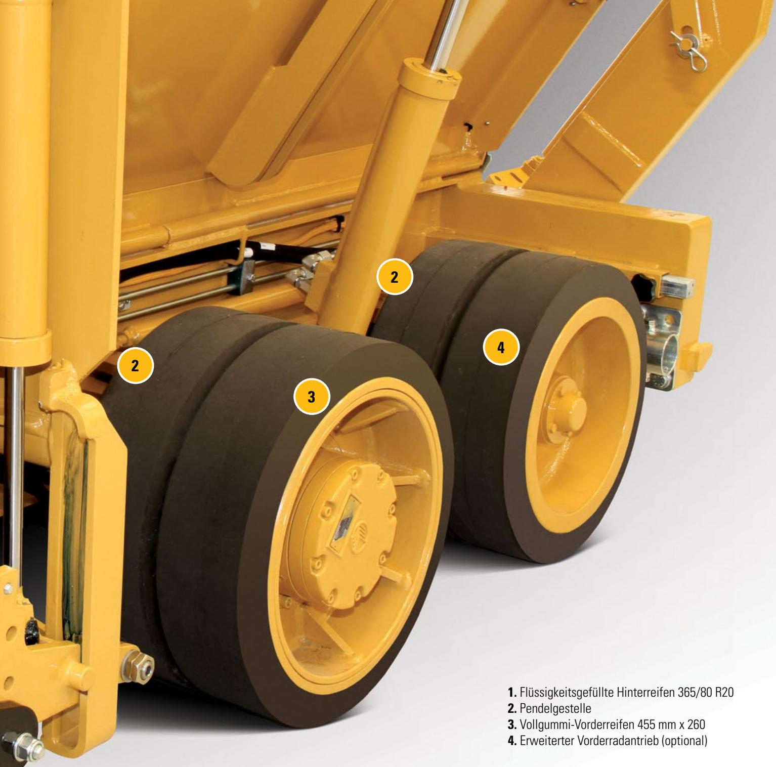
1. Flüssigkeitsgefüllte Hinterreifen 365/80 R20
