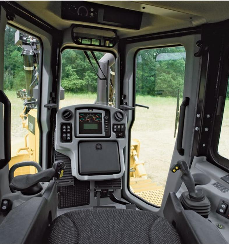
La cabina del modelo D6T se ha diseñado y equipado para conseguir la productividad, seguridad y comodidad del operador. La cabina montada sobre tacos de aislamiento reduce el ruido y la vibración. Las amplias ventanillas de las puertas, la inclinación del capó del motor y la forma del depósito de combustible proporcionan una excelente visibilidad de todos los lados de la máquina y del lugar de trabajo.
