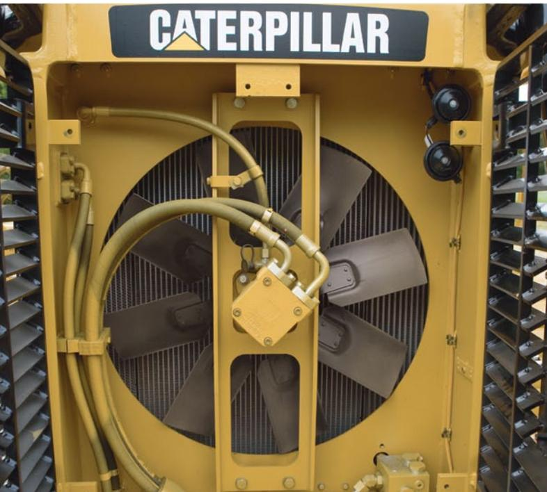
El radiador del motor, el postenfriador aire a aire y el radiador de aceite hidráulico se empaquetan en un único plano. La construcción de la placa de barra de aluminio favorece la durabilidad y permite una mayor transferencia de calor así como una mayor resistencia a la corrosión. Los núcleos estándar presentan 12 láminas por cada 51 mm que dejan pasar la suciedad y reducen los problemas por obstrucciones.
