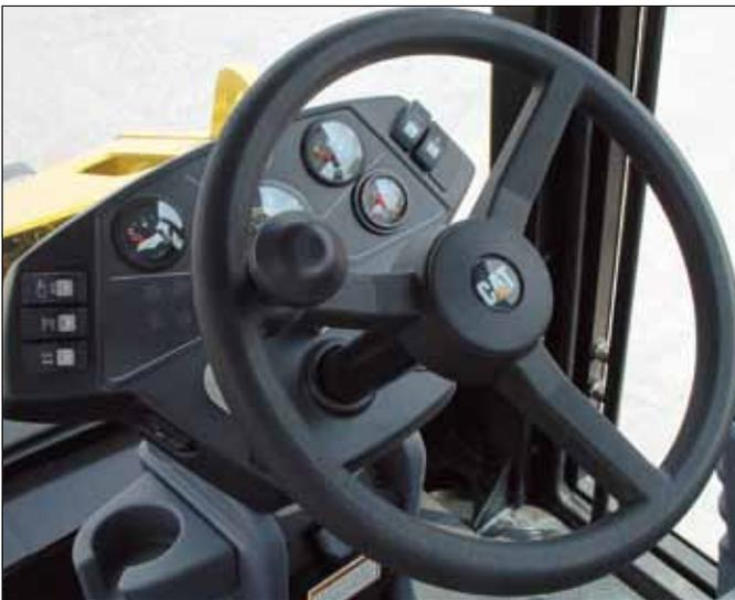
**Эксплуатационные датчики.** Панель рулевого управления и контрольно-измерительные приборы неограниченно регулируются в пределах диапазона наклона под желаемое положение оператора. Вся панель может наклоняться для удобства входа в кабину и выхода из нее.
