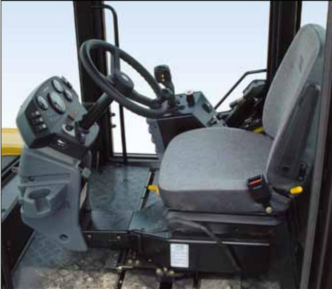
**Сиденье.** Удобное и прочное регулируемое сиденье позволяет регулировать его продольное положение и жесткость подвески. На нем имеются складывающиеся подлокотники и ремень безопасности с инерционной катушкой шириной 76 мм.
