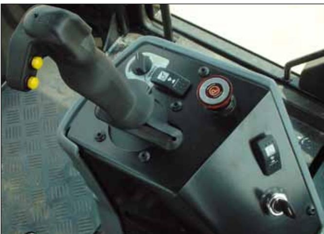
**Рычаг хода.** Многофункциональный эргономичный рычаг хода облегчает управление следующими функциями: скорость хода, включение и выключение вибрации, включение и выключение распыления воды, звуковой сигнал и смещение вальца (дополнительная функция).
