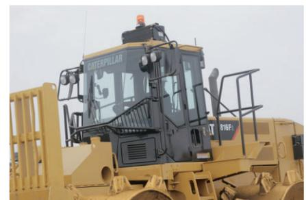
**Condenseur de climatiseur monté sur le toit.** Le condenseur de climatiseur sur charnière s'ouvre en pivotant et peut être associé au refroidisseur d'huile hydraulique, ce qui permet au système de refroidissement d'être nettoyé rapidement et facilement.
