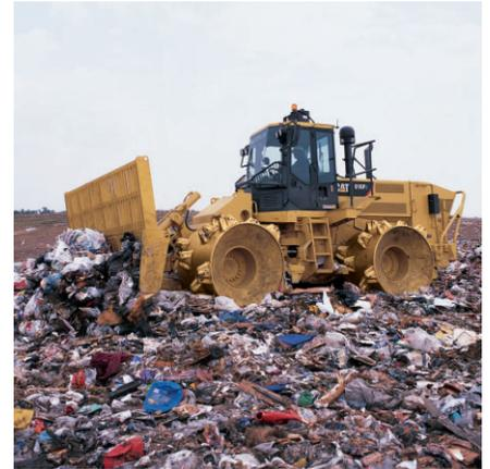
**Protection de vitre avant en option.** Évite que des débris n'endommagent la partie inférieure de la vitre avant grâce à une protection passant le long du bas de la vitre avant de la cabine.
