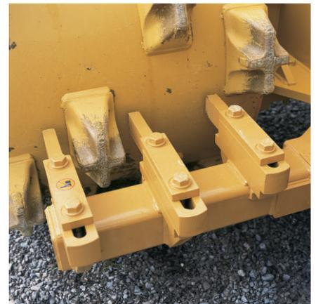
**Doigts de nettoyage des pointes et des roues, en option.** Soudés sur les barres de décrottage de série, ces doigts réglables empêchent le colmatage des roues lors du travail dans des matériaux cohésifs tels que de l'argile ou de la boue.
