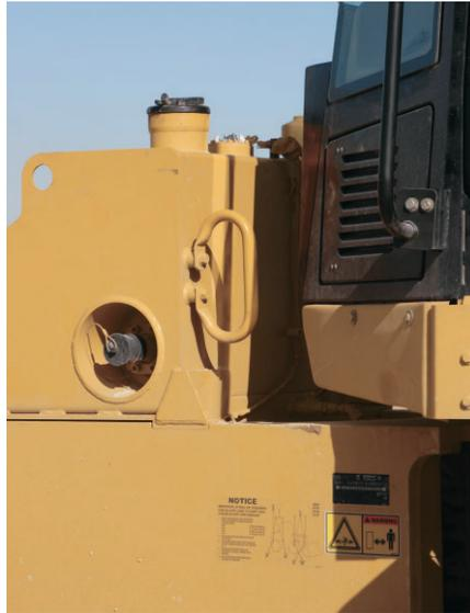
**Réservoir de carburant.** Est facile à atteindre et est positionné à l'écart des débris pour assurer la protection et une capacité maximum.
