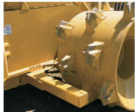
**Barres de décrottage.** Situées à l'avant et à l'arrière des roues arrière et à l'arrière des roues avant, elles offrent une protection contre les débris qui peuvent être projetés ou entraînés par les roues.
