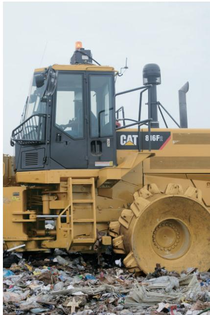
**Plate-forme de gauche.** L'accès à l'arrière de la cabine est facilité grâce à la plateforme gauche.
