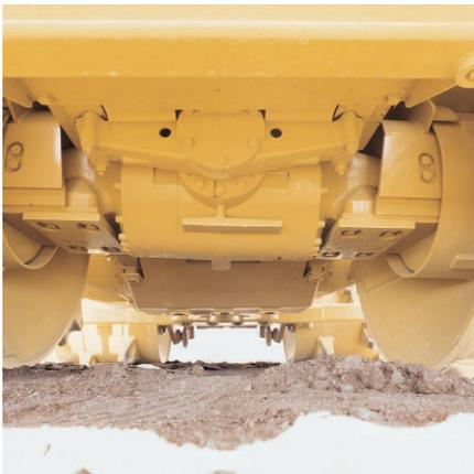
**Blindages à charnières du moteur et de la transmission.** Empêchent les accumulations de débris et protègent des gravats, des débris, des câbles, des armatures de béton et des substances chimiques nocives tout en permettant un nettoyage facile.
