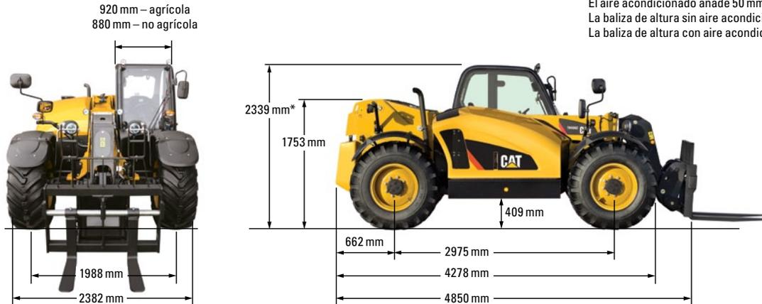
Radio de giro exterior sobre los neumáticos: 3585 mm
