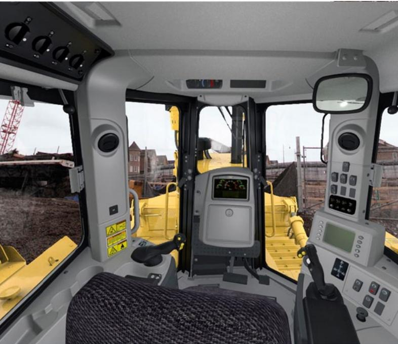
La cabina del D8T se ha diseñado y equipado pensando en la productividad, seguridad y comodidad del operador. Las amplias ventanillas de las puertas, la inclinación del capó del motor y la forma del depósito de combustible proporcionan una excelente visibilidad de todos los lados de la máquina y del lugar de trabajo. Los nuevos equipos de alumbrado estándar y opcionales amplían el día de trabajo productivo.
