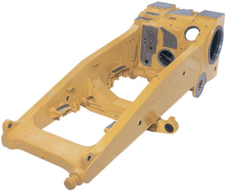
El bastidor principal del D8T se ha construido con fundiciones de acero con una dureza líder en el sector, mientras que los rieles del bastidor de la sección en caja completa y los perfiles laminados continuos en los rieles superiores e inferiores del bastidor ofrecen la resistencia necesaria para absorber las altas cargas de impacto y de torsión.
