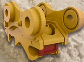
Attache à accouplement par axes Center-Lock™ de Cat
